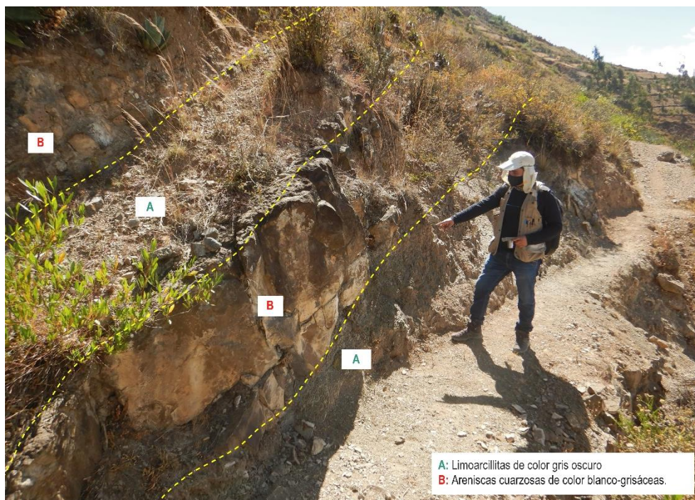
Figura 6. Sustrato rocoso conformado por la intercalación de areniscas cuarzosas y limoarcillitas. Estas rocas se presentan muy fracturas y altamente meteorizadas.
