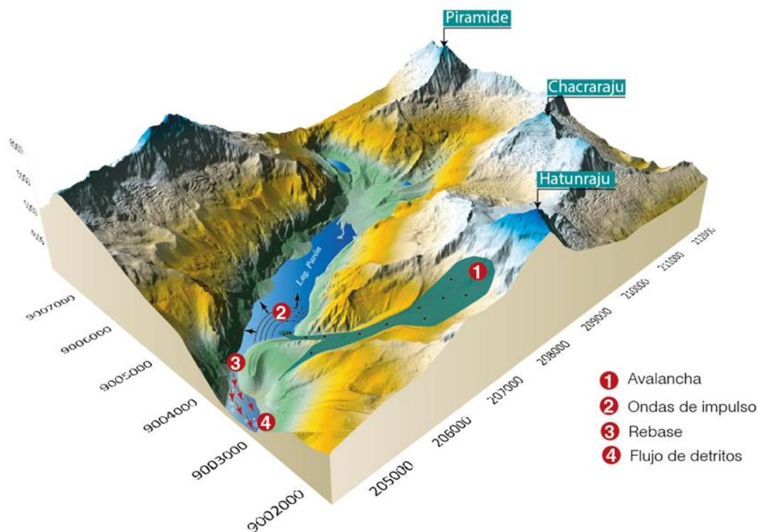
Cabe precisar que, la calidad del modelamiento de la cadena de procesos está en función de los datos de entrada, los resultados empleando datos secundarios y una topografía de mediana resolución, dan como resultado, lo mostrado, una extensa área de inundación en las poblaciones aledañas aguas abajo de la laguna Parón
