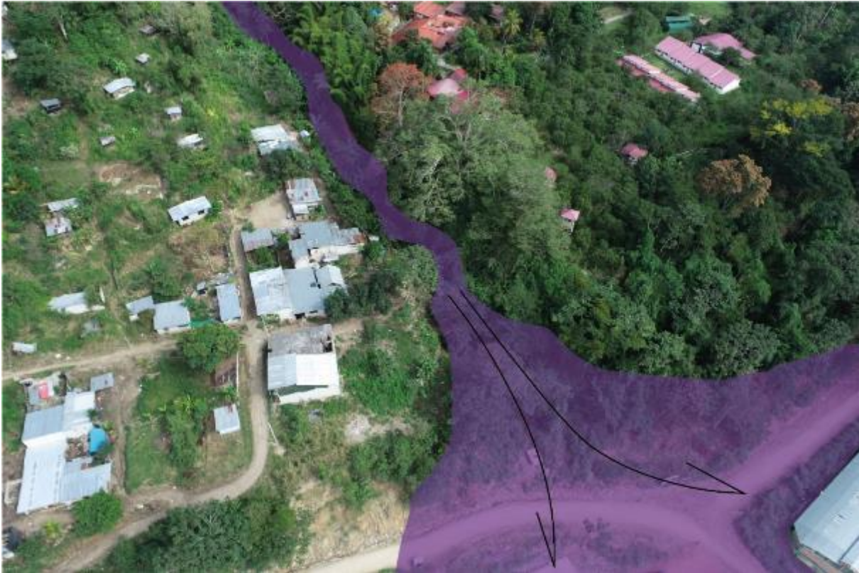
Figura 35. Zona de inundación en la desembocadura de la Quebrada Abanico, por flujo de detritos
