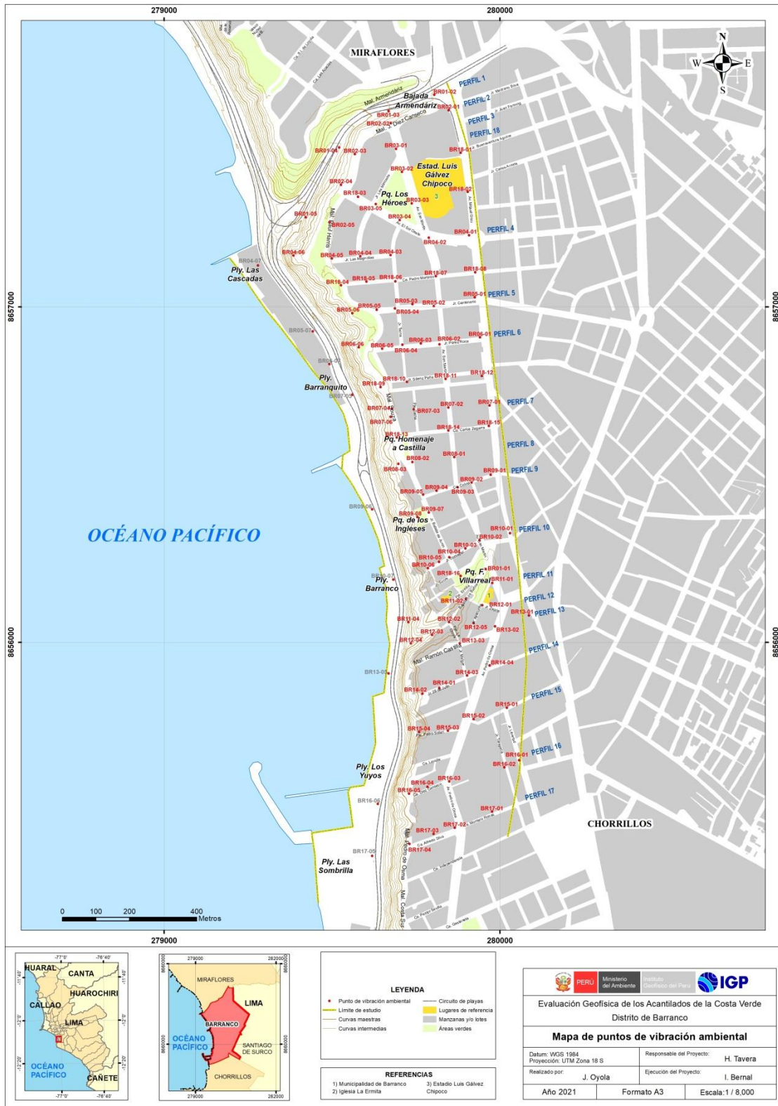
Figura 26. Distribución espacial de los puntos de registros de vibración ambiental, en los ACV del distrito de Barranco. Los perfiles, consideran puntos distribuidos siguiendo líneas perpendiculares al acantilado. Los códigos en gris, corresponden a puntos realizados en la zona baja del acantilado.
