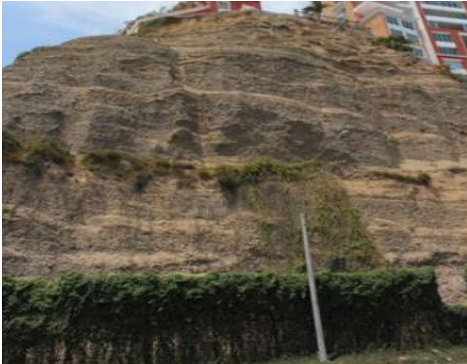
Figura 4: a) Vista de la estratigrafía de los ACV en el distrito de Barranco. Depósito aluvial, gravas sub redondeadas con intercalaciones de lentes de limos (Fuente PNUD, 2014).
