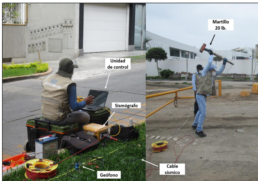
Figura 11. Equipos utilizados en la toma de datos por el método de MASW.
