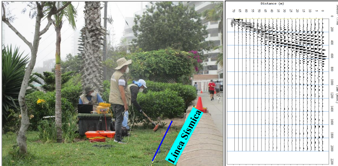
Figura 13. Disposición del equipo de adquisición de datos - MASW (Malecón Paul Harris) y el registro sísmico obtenido.
