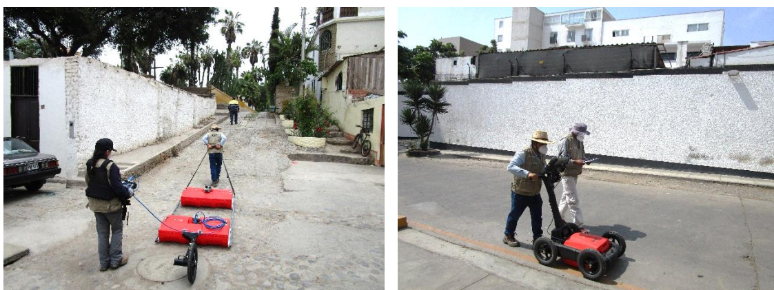
Figura 21. Disposición del georadar utilizando la antena de 100 MHz y 350 MHz.
