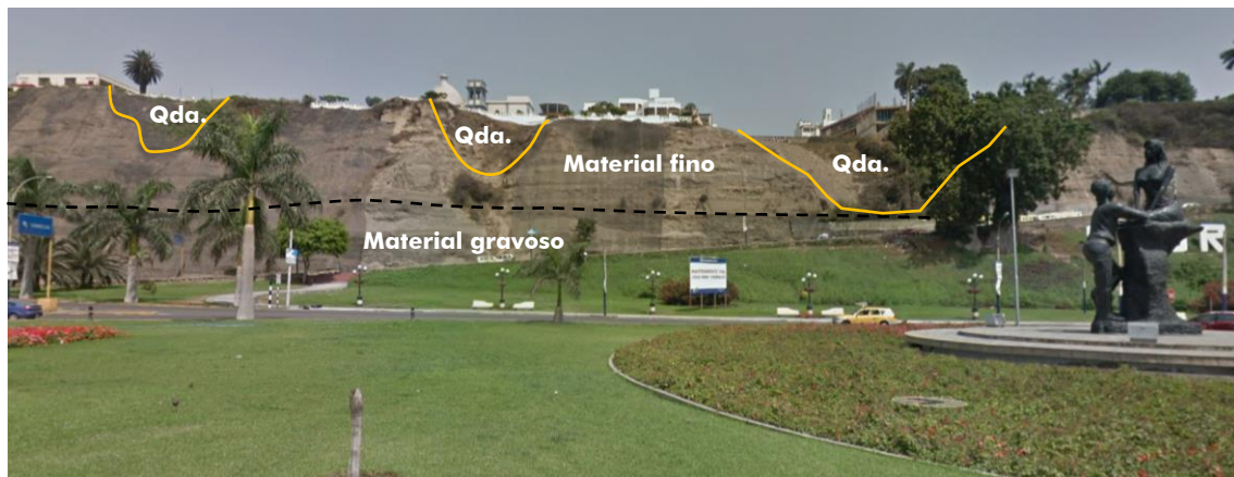
Figura 41. Material aluvial identificado en el acantilado, a la altura de la Pileta Agua Dulce, donde sobresale material fino en la parte superior sobre el material gravoso.
