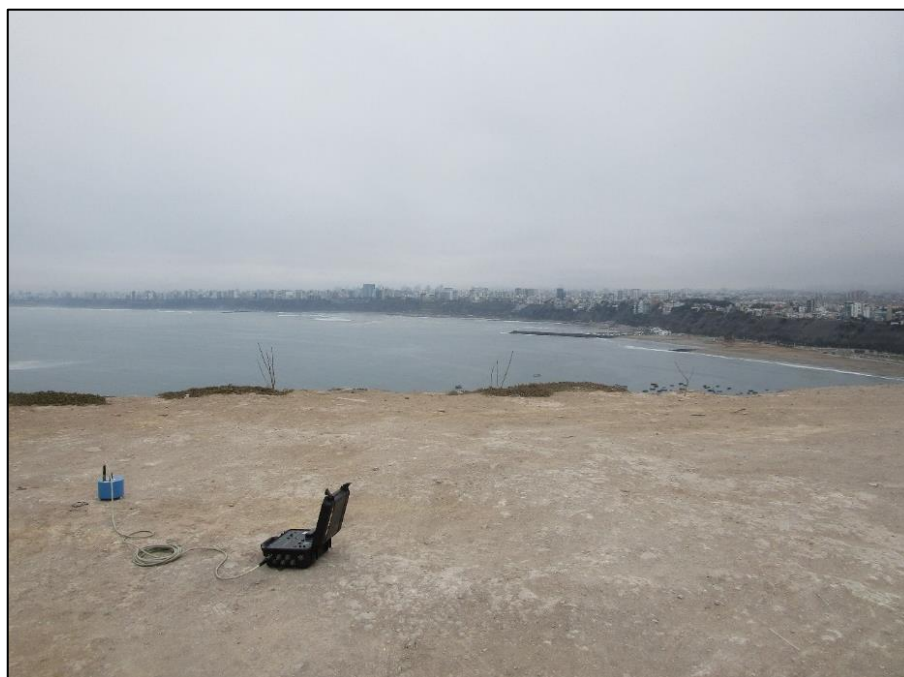
Figura 25. Equipo sísmico utilizado para el registro de vibraciones ambientales: sensor Lennartz (2N) y registradores CityShark II.
