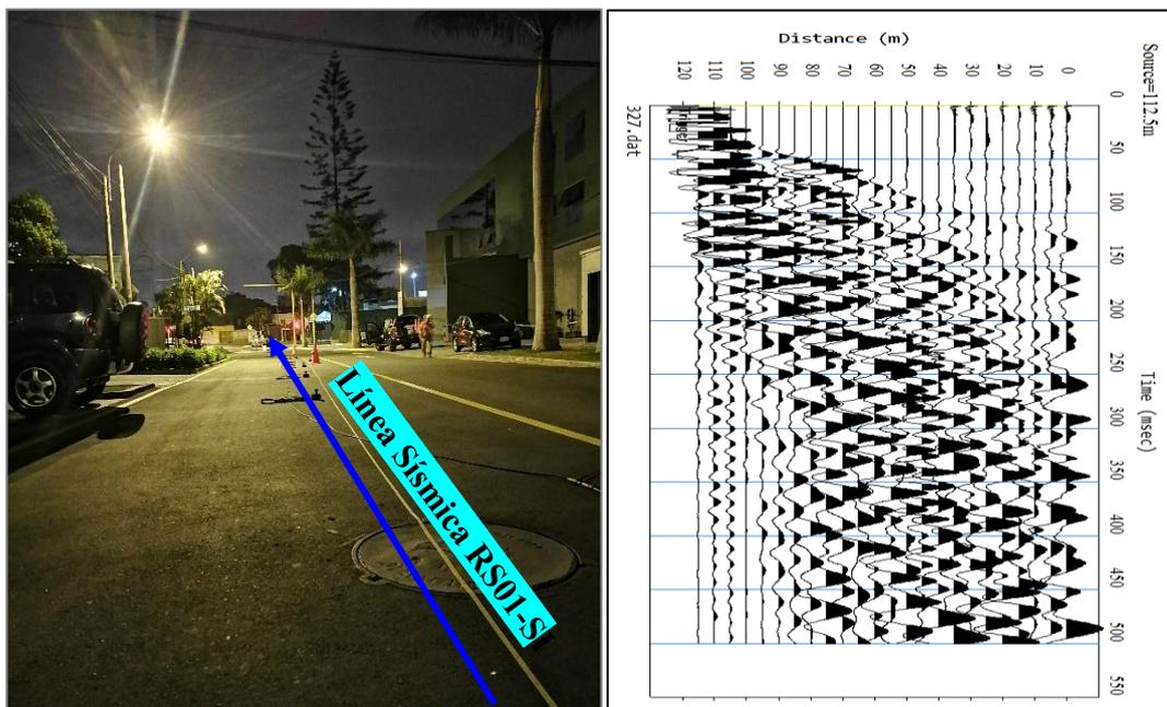
Figura 7. Disposición del equipo de adquisición de datos con la técnica de refracción sísmica (RS01-SI, calle Godofredo García) y registro sísmico obtenido.
