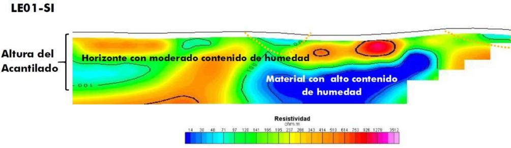
Figura 43. ...Continuación.../. Correlación de los resultados obtenidos con los métodos sísmico y eléctrico, con la cara expuesta del ACV, a la altura del parque Mahatma Gandhi con el Malecón Godofredo García.
