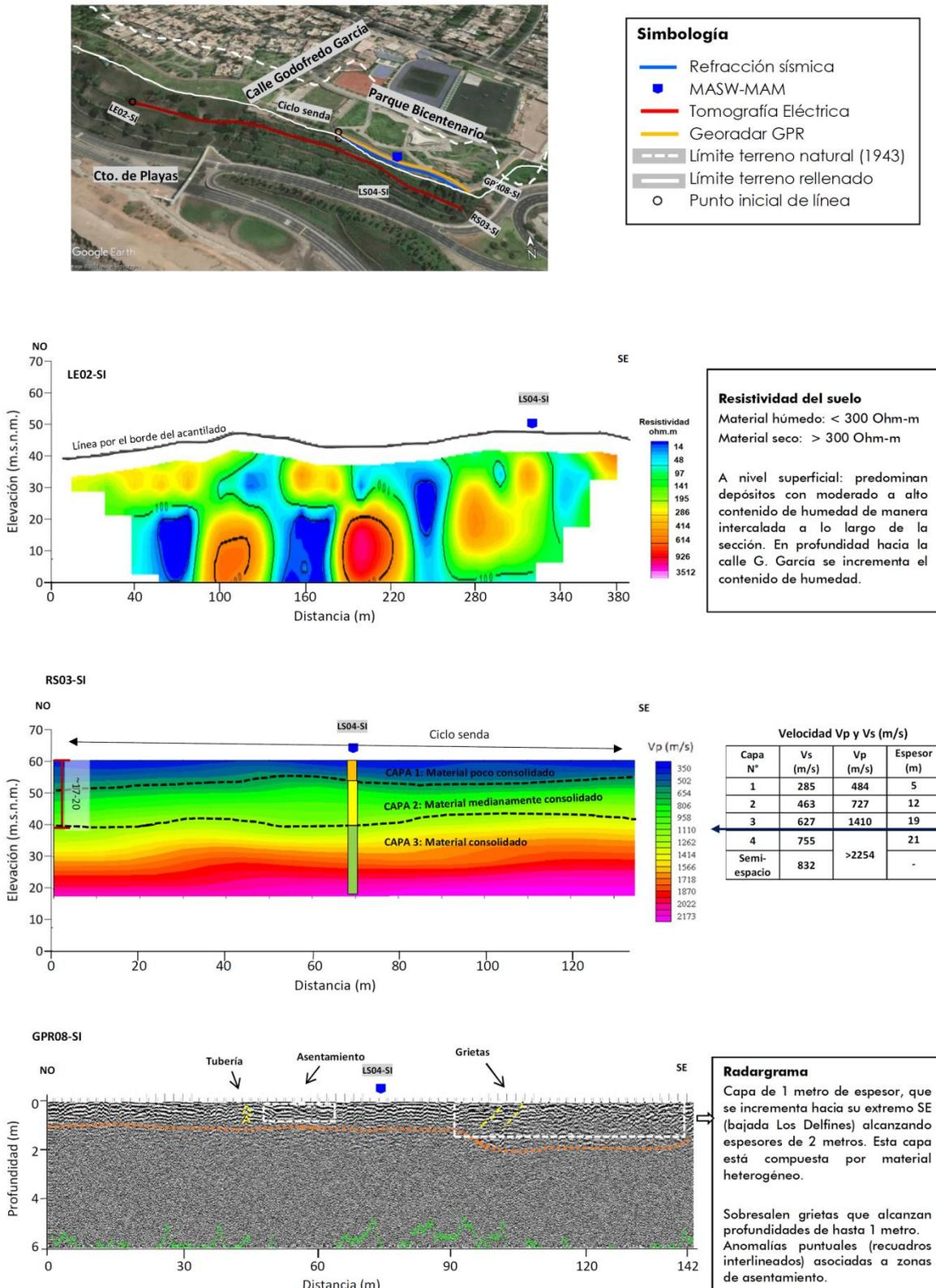
Figura 41. Correlación de los resultados obtenidos con los métodos de tomografía eléctrica, refracción sísmica, MASW-MAM y Georadar para el extremo Sur del distrito de San Isidro (complejo deportivo San Isidro y Bajada Los Delfines).
