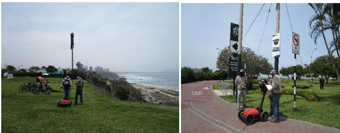
Figura 21. Disposición del georadar utilizando la antena de 350 MHz.
