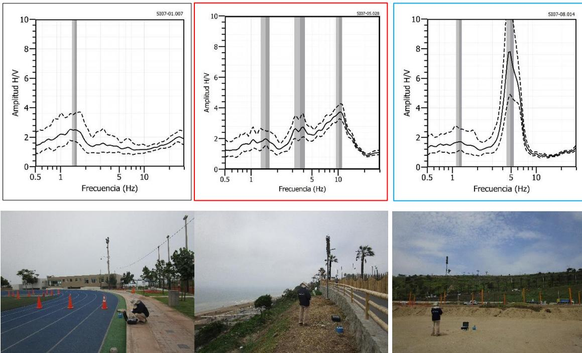
Figura 32. b) Razones espectrales obtenidas para puntos del perfil P-07 (SI07-01, SI07-05 y SI07-08), ubicados de Este a Oeste, a 150 metros del acantilado, sobre el acantilado y el tercero en el Circuito de Playas.
