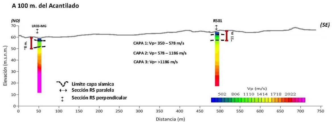
Figura 42. Variación en el espesor de las capas de suelos desde el borde del acantilado hasta distancias de 10 y 100 metros hacia el área urbana. Resultados obtenidos con el método de refracción sísmica (RS01-SI, LR03-MG).
