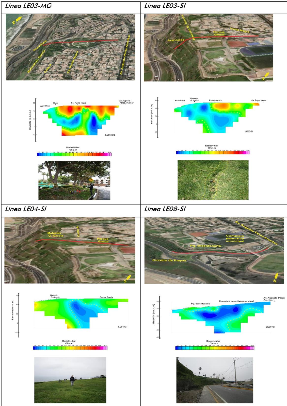
Figura 19. ...Continuación.../. Ubicación y orientación de las líneas de tomografía eléctrica realizadas en los extremos NO (LE03-MG, LE03-SI) y SE (LE04-SI y LE08-SI) de los ACV. Las líneas discontinuas delimitan las zonas con mayor contenido de humedad en cada sección, así como su proyección en el perfil del acantilado.
