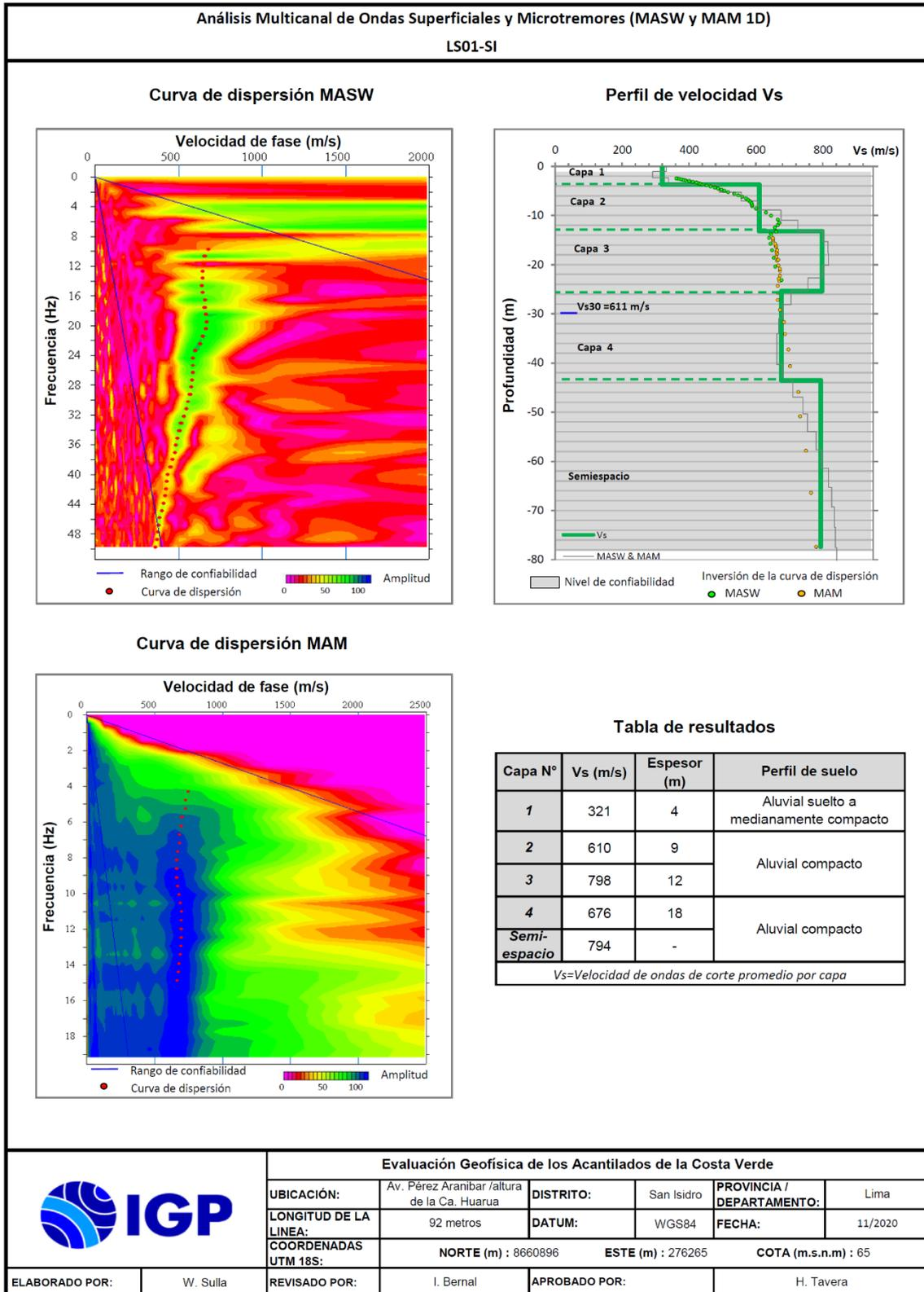
Figura 15. Resultados obtenidos con el ensayo MASW y MAM para la línea sísmica LS01-SI.
