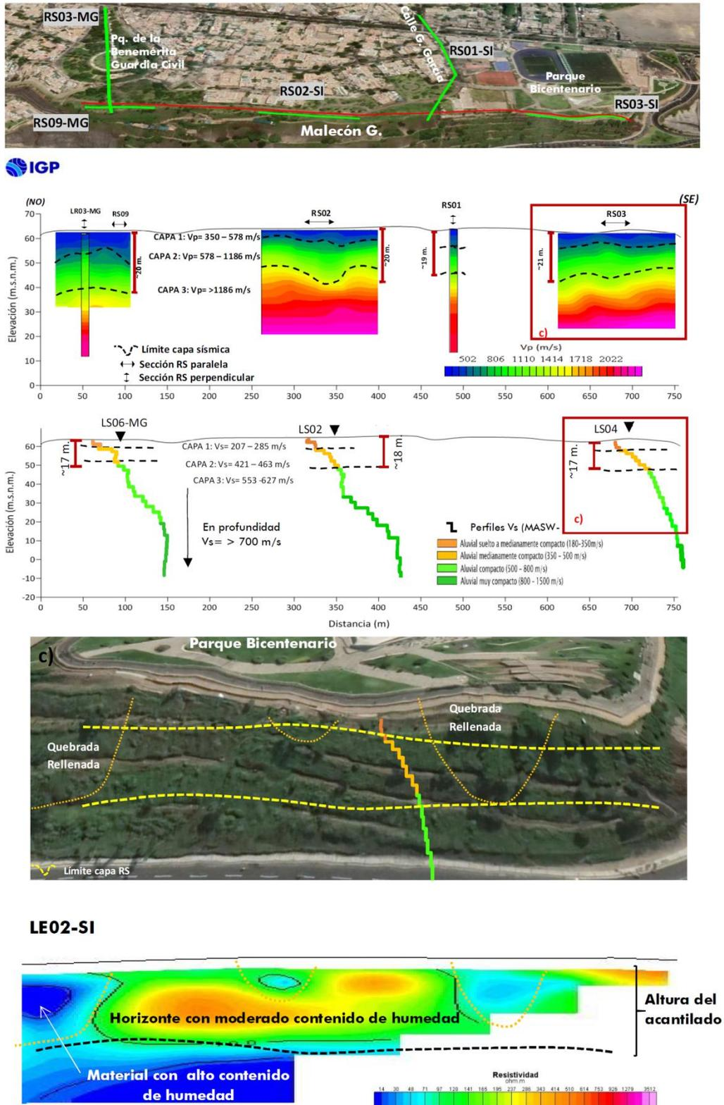
Figura 43. ...Continuación.../. Correlación de los resultados obtenidos con los métodos sísmico y eléctrico, con la cara expuesta del ACV, a la altura del parque Bicentenario.
