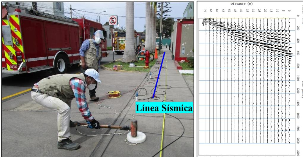
Figura 13. Disposición del equipo de adquisición de datos - MASW (calle Godofredo García) y registro sísmico obtenido.
