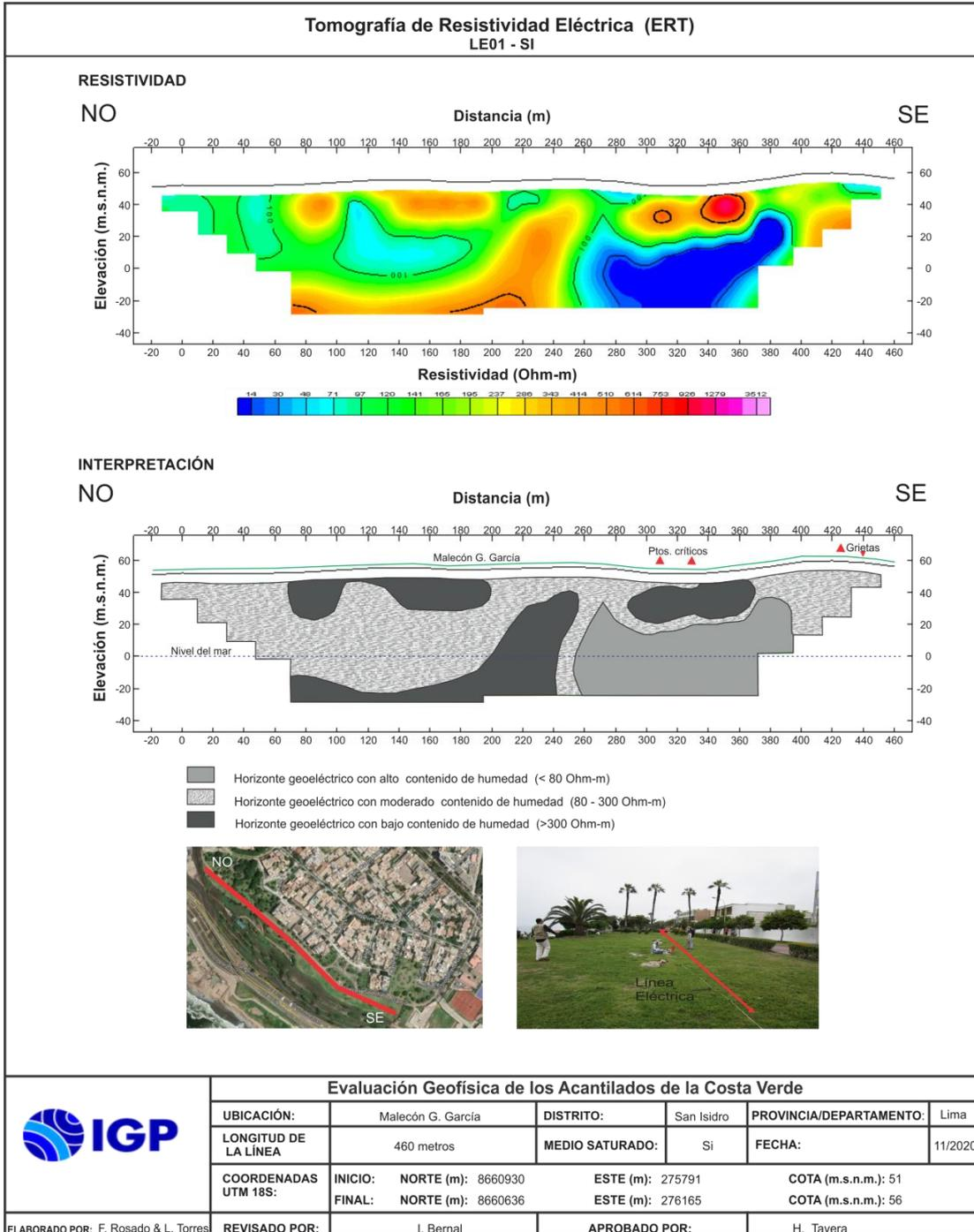
Figura 18: Resultado de tomografía eléctrica para la línea LE01-SI.
