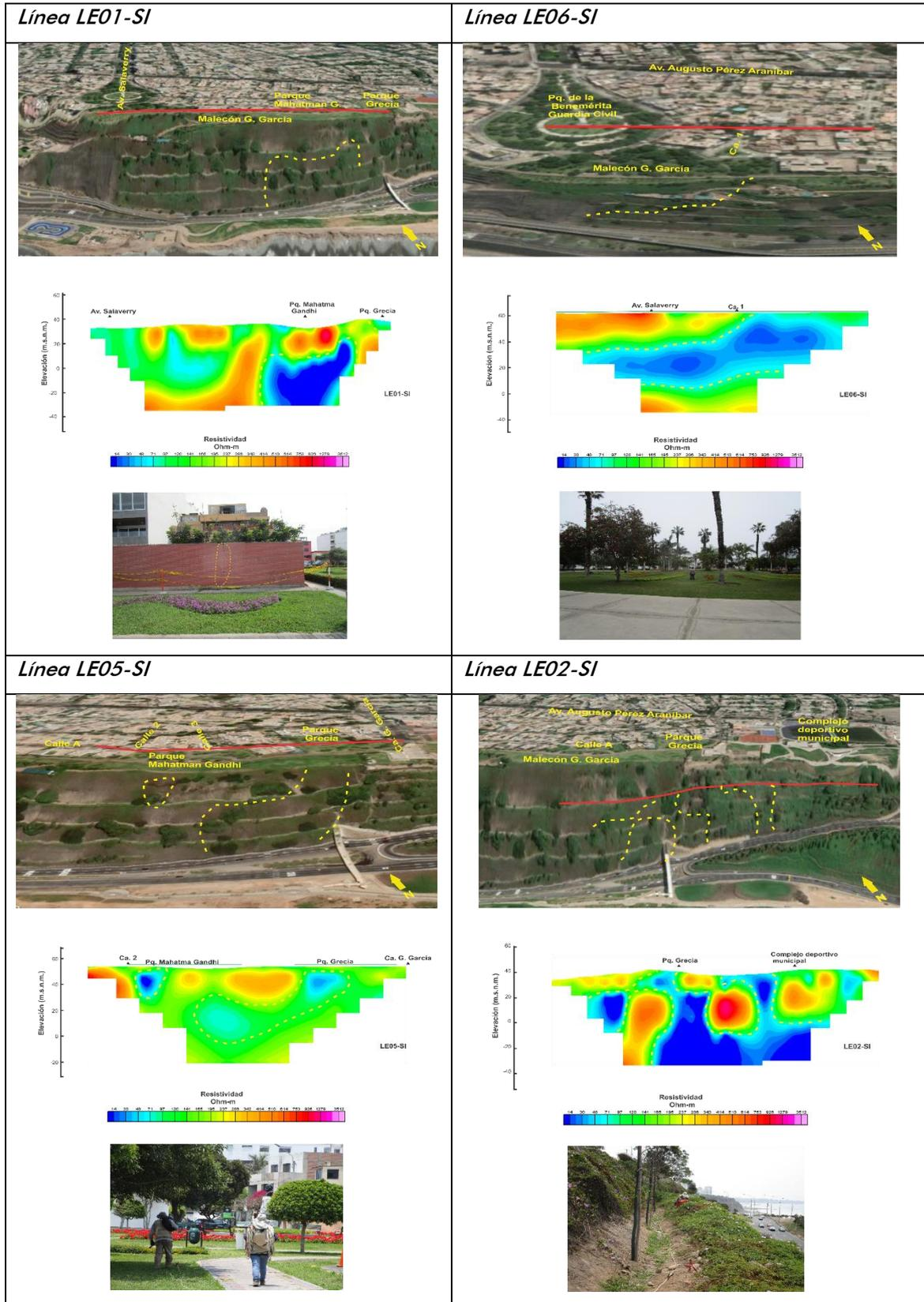
Figura 19. Ubicación y orientación de las líneas de tomografía eléctrica realizadas en el extremo NO (LE01-SI y LE06-SI), Central (LE05-SI y LE02-SI) de los ACV. Las líneas discontinuas delimitan las zonas con mayor contenido de humedad en cada sección, así como su proyección en el perfil del acantilado.
