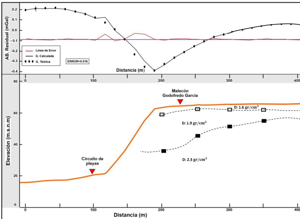
Figura 37. Perfil gravimétrico SI01 con orientación suroeste-noreste. En el extremo superior, los puntos representan la gravedad observada y la curva negra la gravedad calculada. En el extremo inferior se muestra el perfil gravimétrico propuesto.
