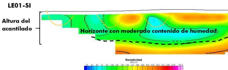
Figura 43. Correlación de los resultados obtenidos con los métodos sísmico y eléctrico, con la cara expuesta del ACV, a la altura del parque de la Benemérita Guardia Civil con el Malecón Godofredo García.
