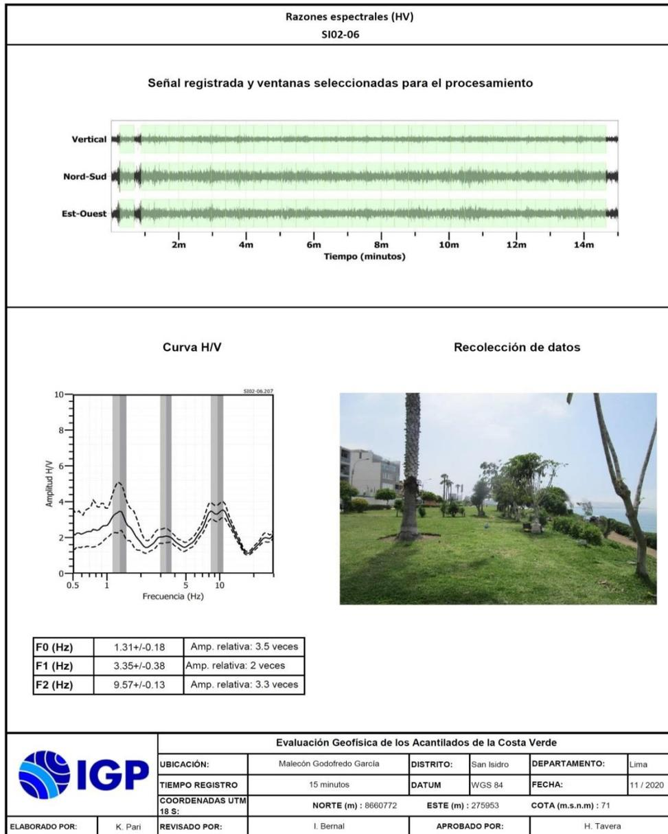
Figura 28. Resultados obtenidos con el método de razones espectrales (H/V) para el punto SI02-06. Arriba, la señal registrada y abajo la curva promedio de las razones espectrales (H/V) en línea gruesa y su desviación estándar en líneas discontinuas. Las barras grises, definen la frecuencia predominante.
