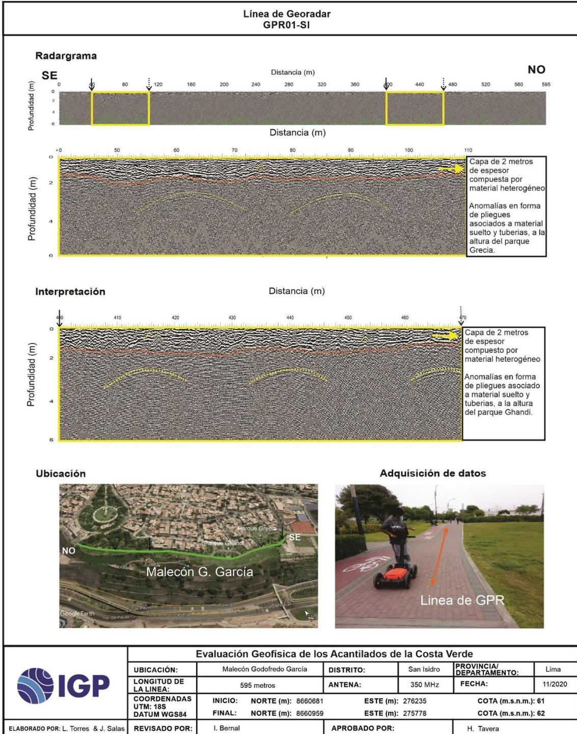
Figura 24. Resultados obtenidos con la técnica de georadar para la línea GPR1-SI.
