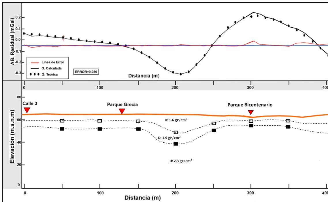
Figura 38. Sección gravimétrica SI02, orientada de noroeste-sureste. En el extremo superior, los puntos representan la gravedad observada y la curva negra la gravedad calculada. En el extremo inferior se muestra el perfil gravimétrico propuesto.
