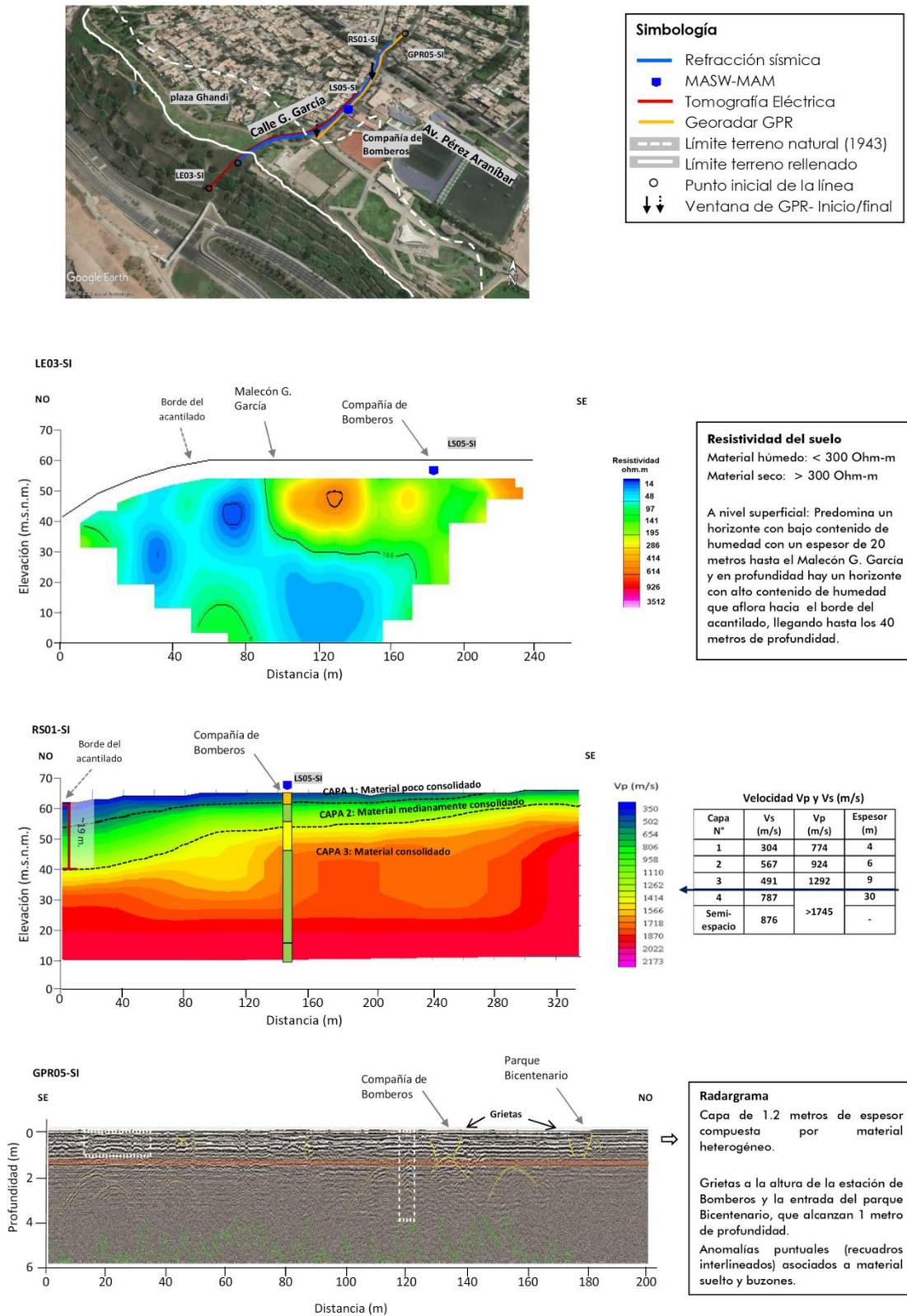
Figura 40. Correlación de los resultados obtenidos con los métodos de tomografía eléctrica, refracción sísmica, MASW-MAM y georadar para el sector central del distrito de San Isidro (Calle 2 y complejo deportivo San Isidro).
