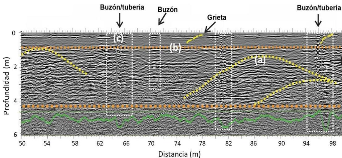
Figura 23. Radargrama, con los diferentes tipos de reflectores asociados a anomalías de tipo hiperbólico (a), lineal (b) y puntuales (c).
