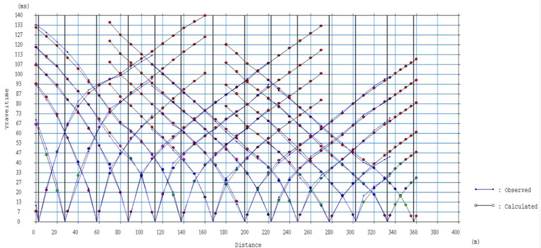
Figura 8. Curvas de tiempo - distancia obtenidas para la línea sísmica RS01-SI.
