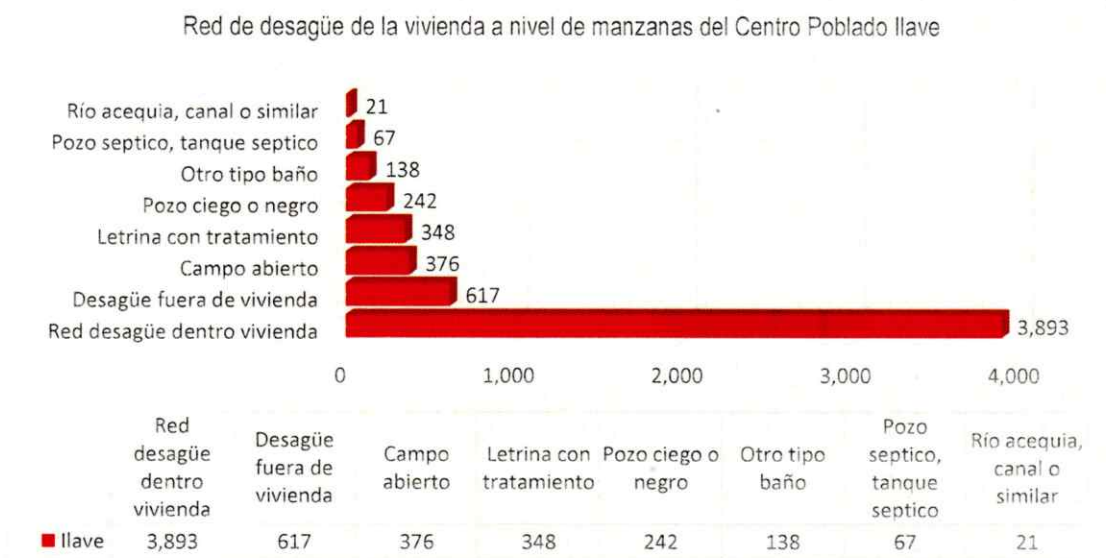
Ilustración 13 Red de desagüe de la vivienda a nivel de manzanas del Centro Poblado Ilave
