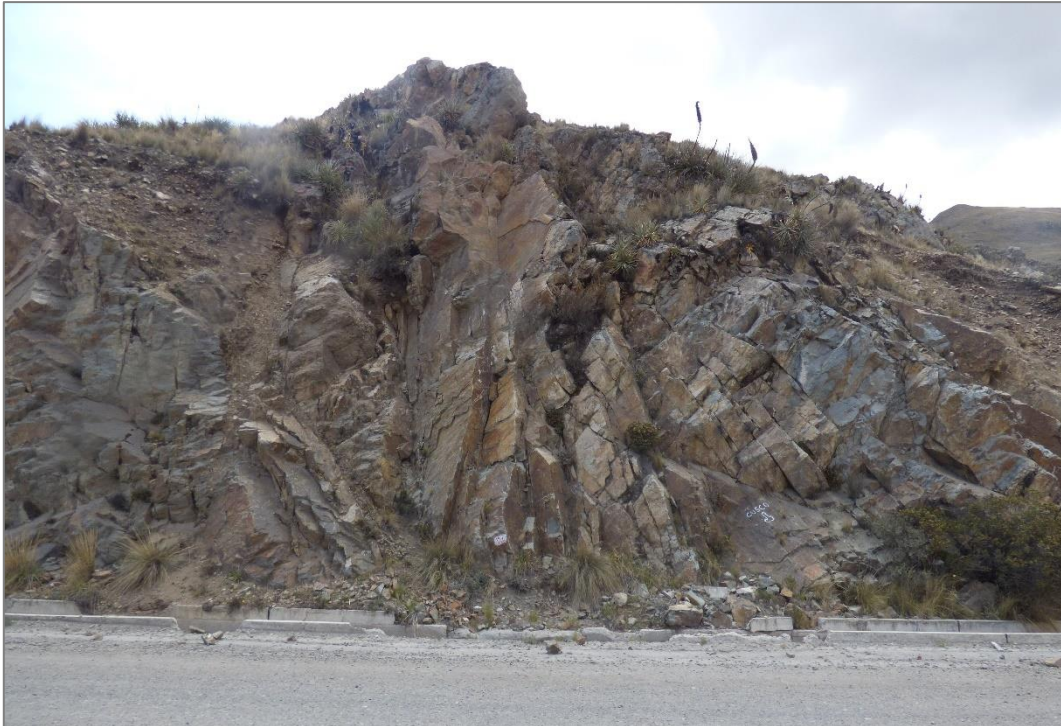
Fotografía 2. Vista de tobas mediana a muy fracturadas y moderadamente meteorizadas del volcánico Palta Kayán. Coordenadas UTM (WGS 84): 262672 E, 8886541 N a 4041 m s.n.m
