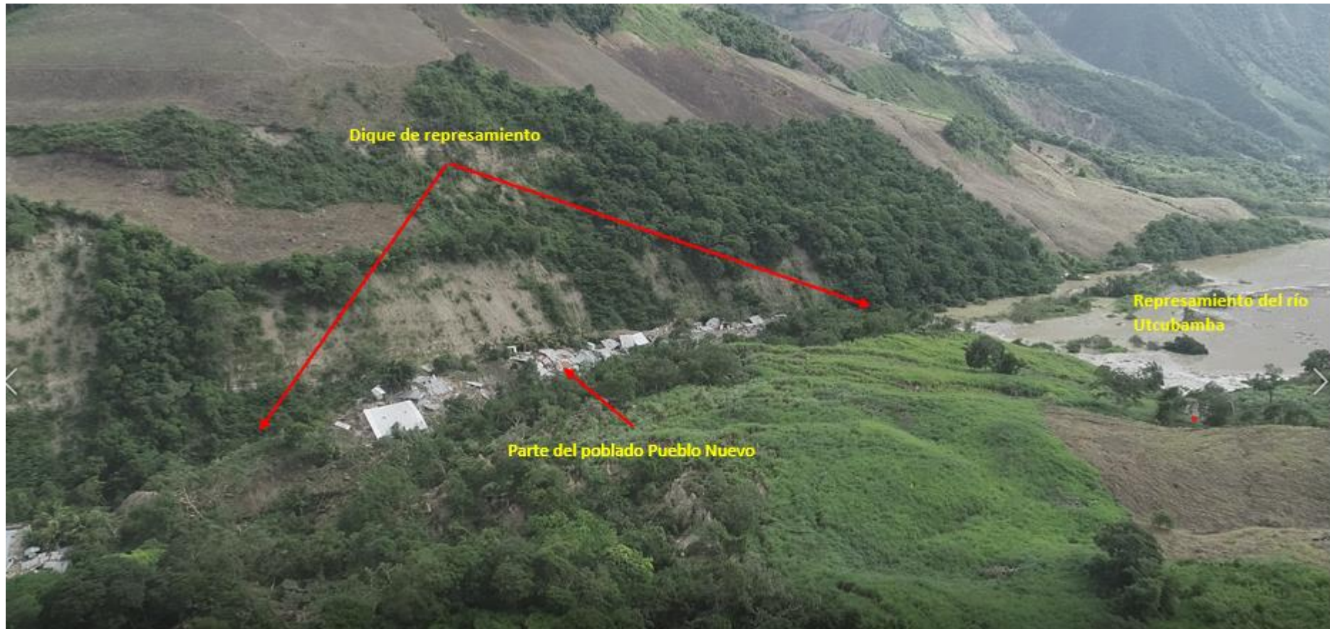
Figura 7. Se aprecia el dique de represamiento del río Utcubamba y parte del poblado de Pueblo Nuevo destruido. Se observa también, el run up sobre la margen derecha. Fuente: Fotografía extraída de un video proporcionado por la Fuerza Aérea del Perú.
