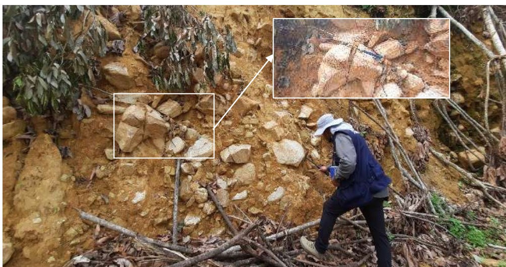
Fotografía 5: Vista de una mezcla de fragmentos heterogéneos sub-angulosos envueltos en una matriz limo-arenosa, en el corte de carretera ubicada a 10 metros del río Túpac Amaru II.
