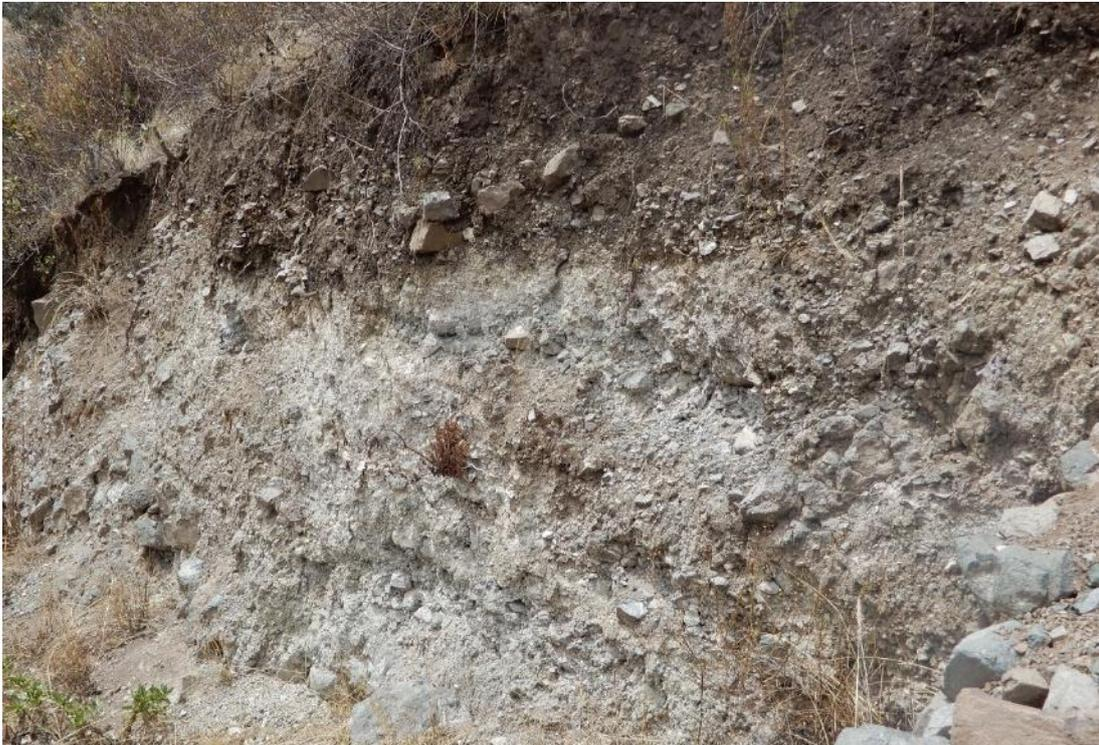
**Fotografía 1.** Material de depósito coluvio-deluvial compuestos por fragmentos de roca angulosos de tamaños variables envueltos en una matriz areno-arcilloso.
