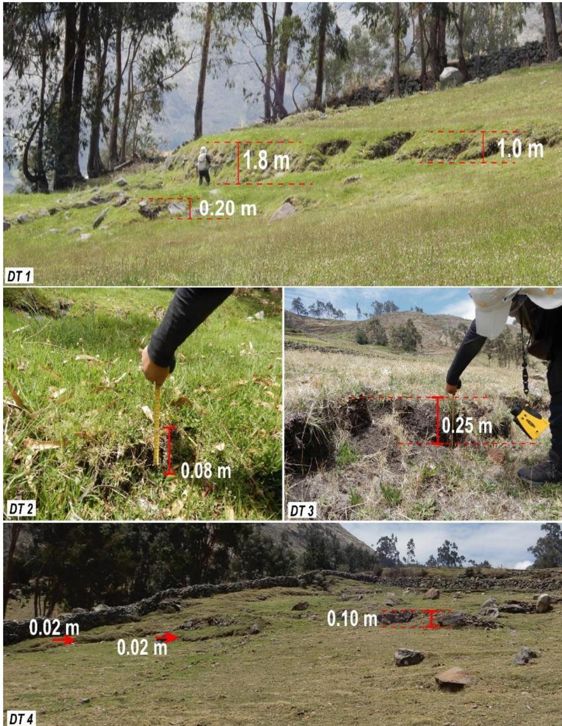
**Figura 13.** Ocurrencias de asentamientos con desniveles de terreno que varían entre 0.22 a 1.8 m, evidenciados en el cuerpo del deslizamiento-flujo.
