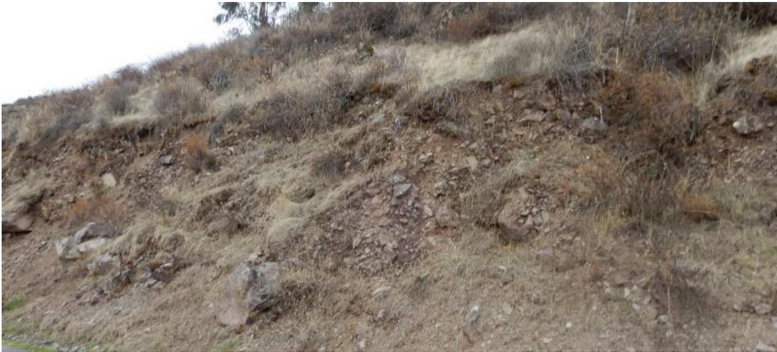
Fotografía 6: Depósito coluvio-deluvial conformado por fragmentos de rocas heterométricas y angulosas envueltos en una matriz areno-arcilloso.
