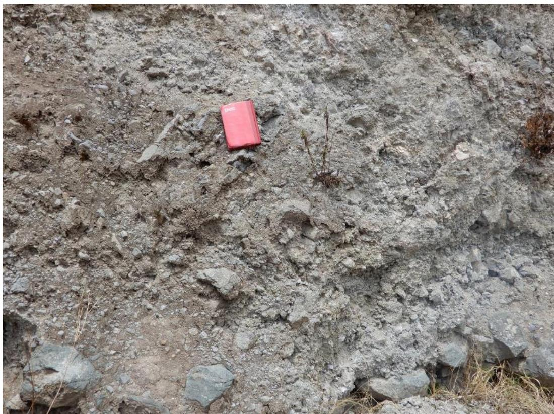
Fotografía 8. Depósito coluvio-deluvial conformado por fragmentos de rocas heterométricos y angulosas envueltos en una matriz areno-arcilloso.
