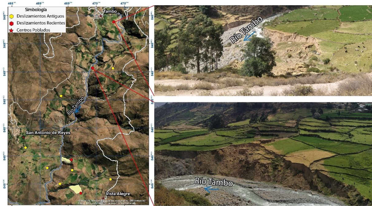
Figura 26. Deslizamientos antiguos y recientes divisados en las márgenes del río Tambo entre los caseríos de San Antonio de Reyes, Tambo y Vista Alegre.
