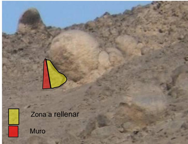
Foto 10. Se muestra esquemáticamente el muro y la zona a ser rellenada para formar una cuña.
