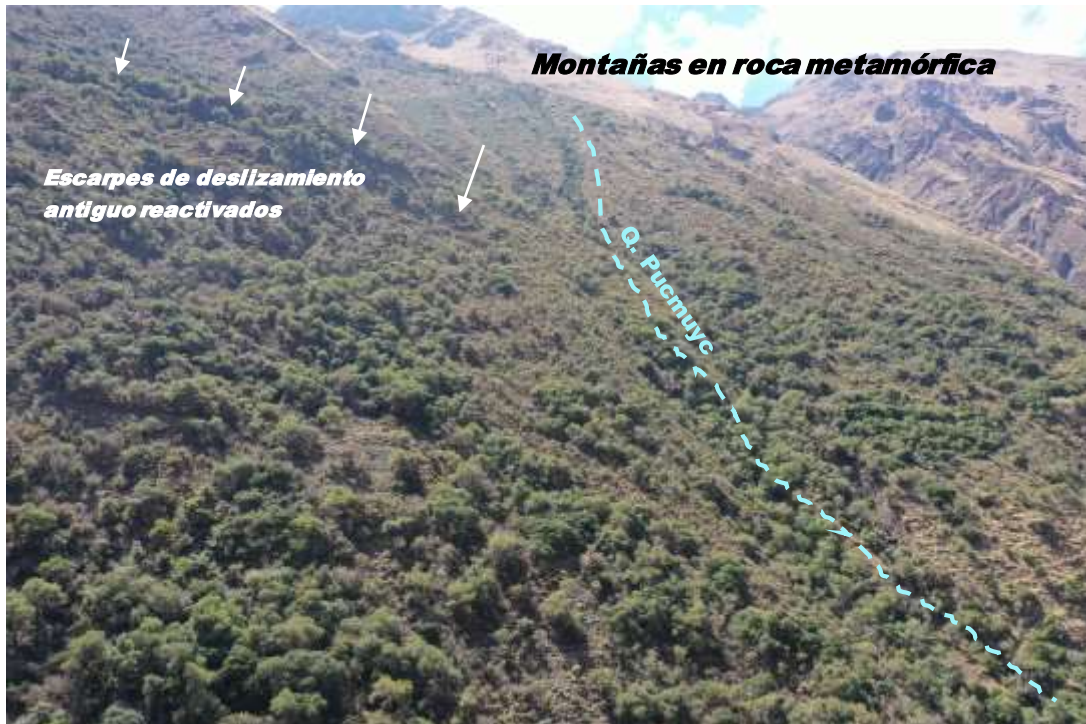
Fotografía 9: Vista de escarpes de deslizamientos antiguos reactivados en el flanco izquierdo del valle del río Abra Málaga, cubiertos por abundante vegetación. Y vista de la quebrada Pucmuyuc cortando geomorfología montañosa.
