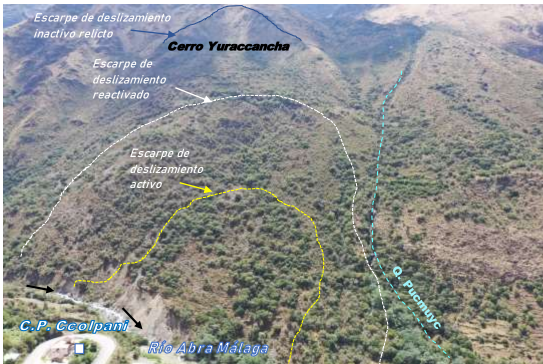
Fotografía 18: Vista de los escarpes de los deslizamientos activo y reactivado en el flanco izquierdo del río Abra Málaga, sobre pendientes de fuerte a muy fuerte inclinación.
