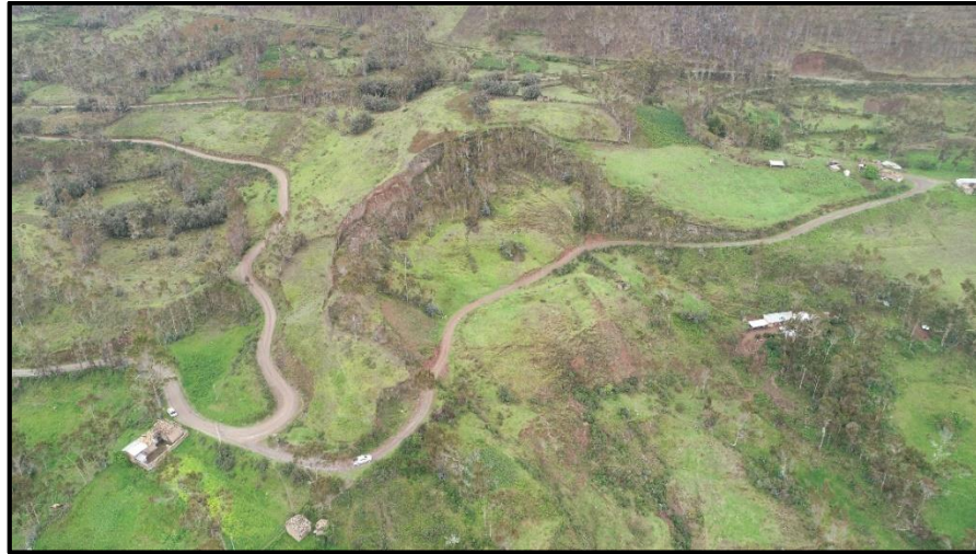
Imagen N° 12: Vista del Suroeste, se puede observar depósitos de deslizamiento, con materiales de origen cuaternario “suelos”.
