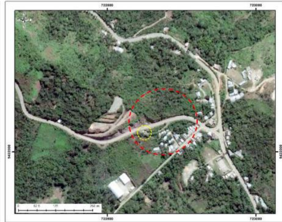
Figura 11: Comparación de imágenes satelitales años 2011 – 2018, el círculo amarillo corresponde a la zona de deslizamiento. En la imagen izquierda, se aprecia que una parte de la Vía de Evitamiento aún estaba en construcción (círculo rojo) y en la derecha está completamente finalizada. Nótese que el deslizamiento abarca parte de la antigua carretera afirmada (material alóctono) y limolitas muy alteradas.
