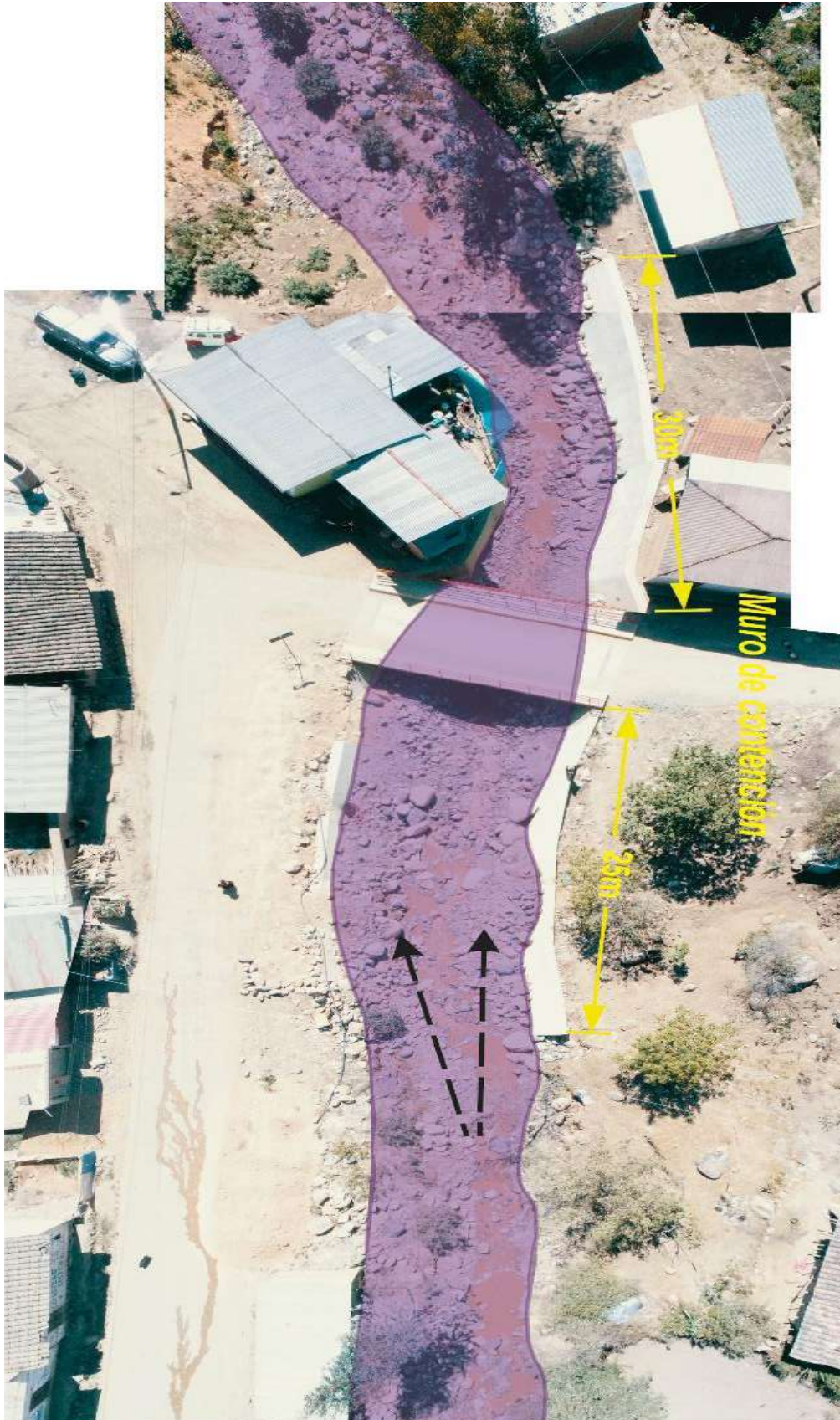
Figura 10. Vista tomada con el dron con fecha 24 de julio del 2021, que permite delimitar los depósitos de flujos de detritos, que cruza por el sector Molino.
