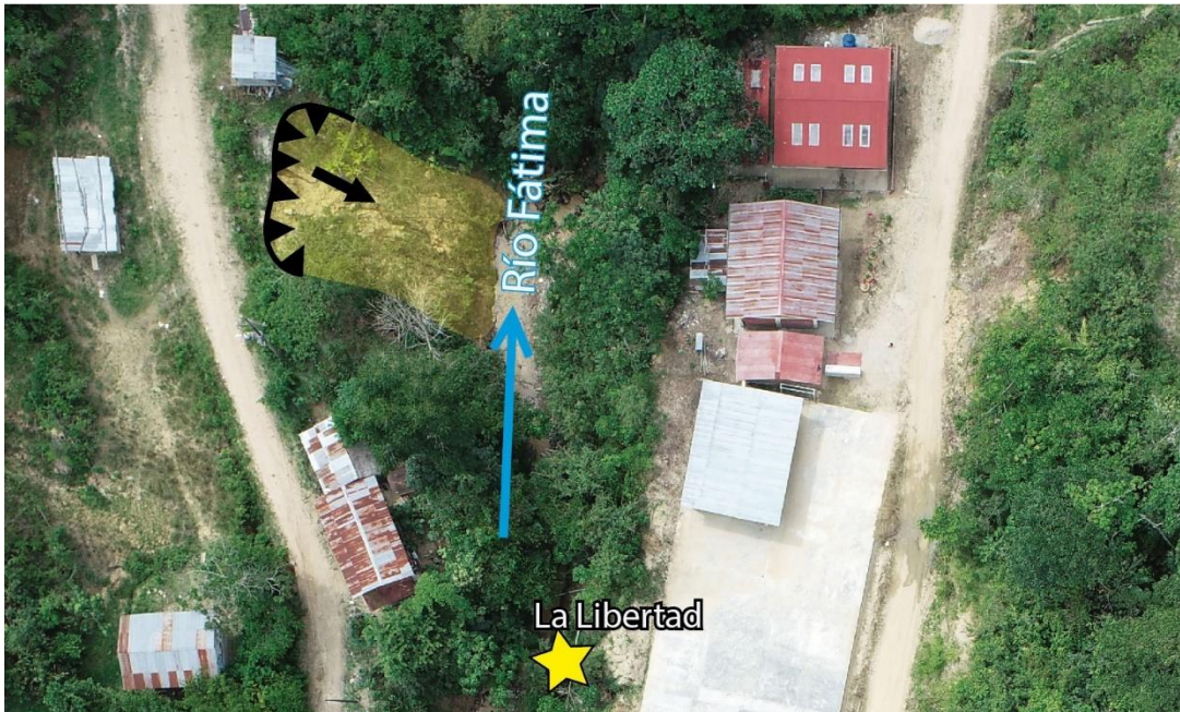
Figura 5. Deslizamiento rotacional ubicado en la margen izquierda del río Fátima .
