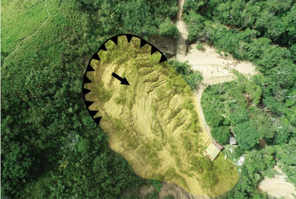
Figura 4. Deslizamiento rotacional ubicado en las coordenadas UTM WGS 84, 18s, X: 539814; Y: 8744230; Z: 1097 m s.n.m.
