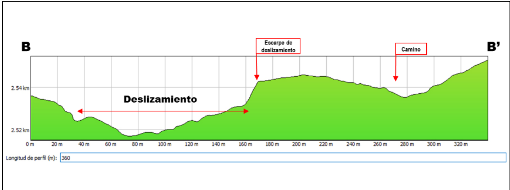
Figura 14. El perfil B-B' es transversal a la dirección del deslizamiento, topográficamente se determina una depresión en el área afectada.
