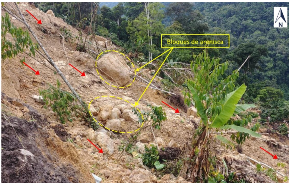
Figura 4. En la parte alta se aprecia el depósito coluvial compuesto de clastos y bloques con tamaños que van desde los 2 cm. hasta 1 m.
