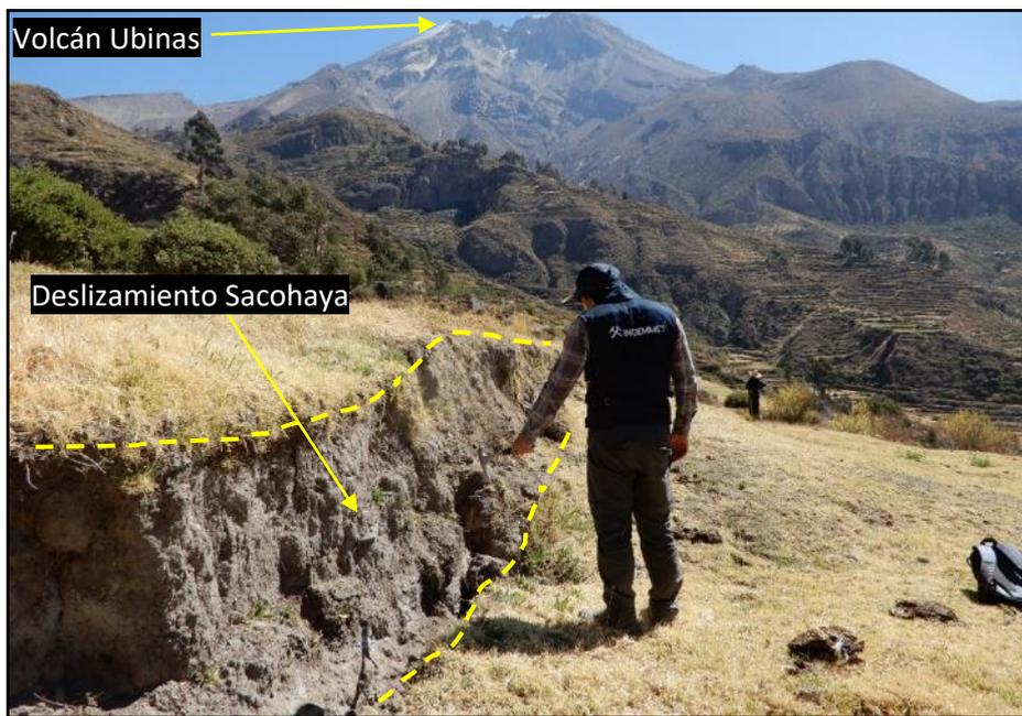
**Figura 15.** Escarpe del deslizamiento Sacohaya, al fondo se visualiza el volcán Ubina, (coordenadas UTM WGS84: 300061E, 8186410N)
