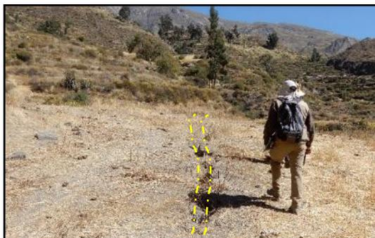
**Figura 17.** Agrietamientos en el cuerpo del deslizamiento (coordenadas UTM E: 300053, N: 8186578)
