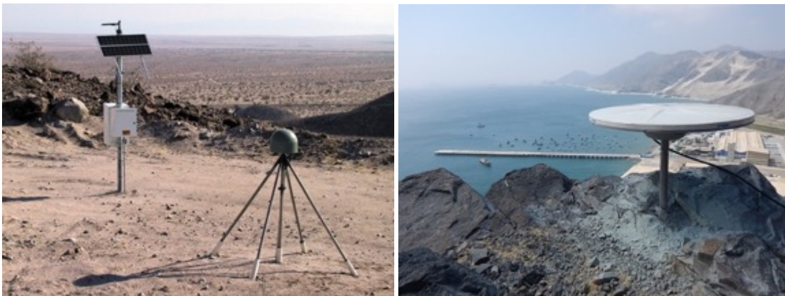
Figura 5. Estaciones GNSS de monitoreo permanente (izquierda) y de campaña (derecha). (Fotos de Tomado de UNAVCO y de una estación ubicada en el departamento de Ancash en este estudio).
