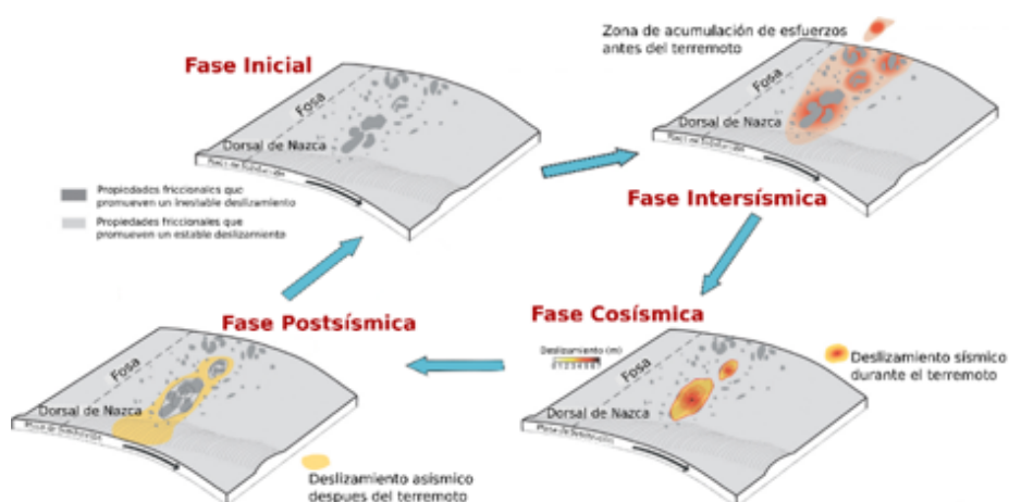
Figura 4. Esquema representativo del ciclo sísmico, donde se muestra los procesos de acumulación y relajación de esfuerzos en las fases principales: fase intersísmica, fase cosísmica y fase postsísmica. Modificado de www.tectonics.caltech.edu/ .
