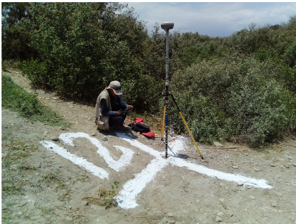
Figura 1. Punto de fotocontrol VIR12. Se observa al operador y al equipo GNSS rover realizando la adquisición de datos.
