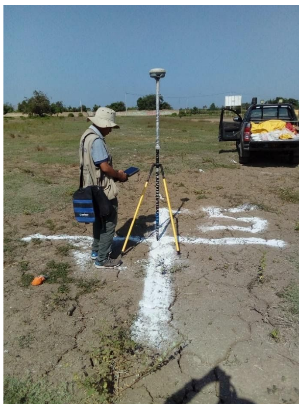
Figura 1. Punto de fotocontrol SJE05. Se observa al operador y al equipo GNSS rover realizando la adquisición de datos.
