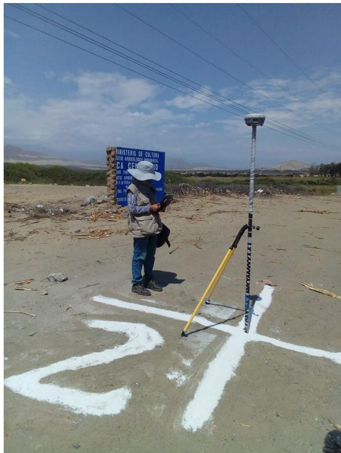
**Figura 1.** Punto de fotocontrol CHA02. Se observa al operador y al equipo GPS rover realizando la adquisición de datos.
