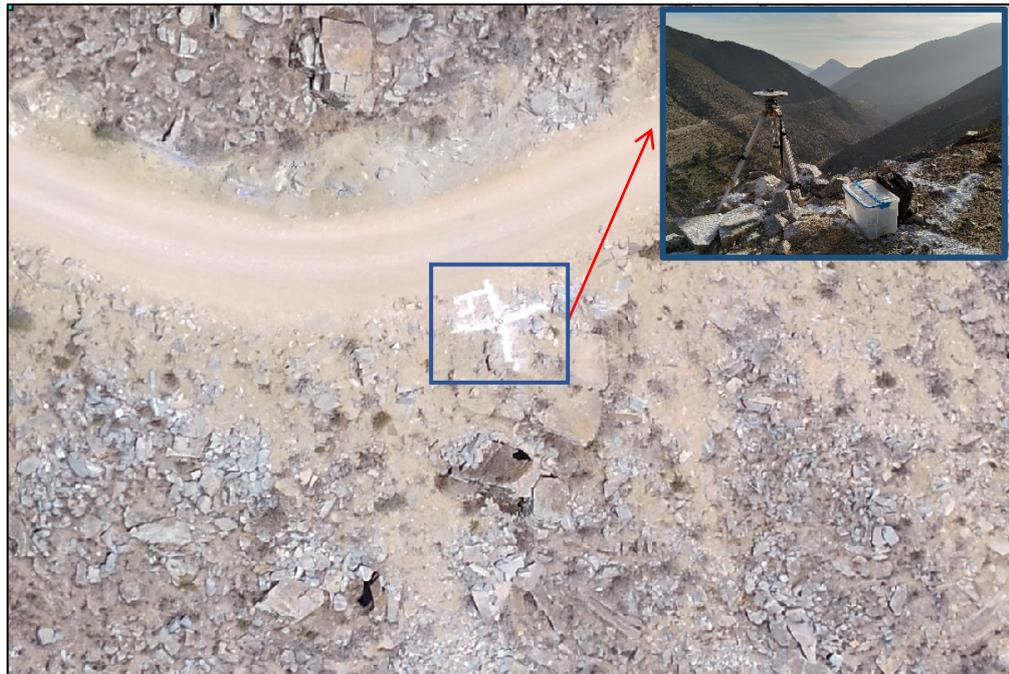
**Foto 1.** Fotografía aérea donde se logra divisar el punto de fotocontrol SY04, debidamente señalizado (marca y numero de fotocontrol correspondiente), ubicado en la localidad de San Juan de Yanac.
