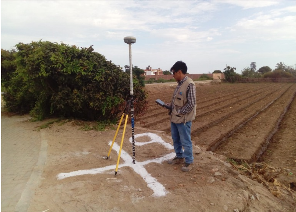
Figura 1. Punto de fotocontrol CSO09. Se observa al operador y al equipo GPS móvil (rover) realizando la adquisición de datos
