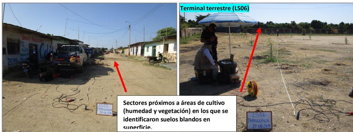
Figura 14. Ensayos MASW ubicados al oeste (LS08) y norte (LS06) del área urbana, cuyos suelos son blandos en superficie.
