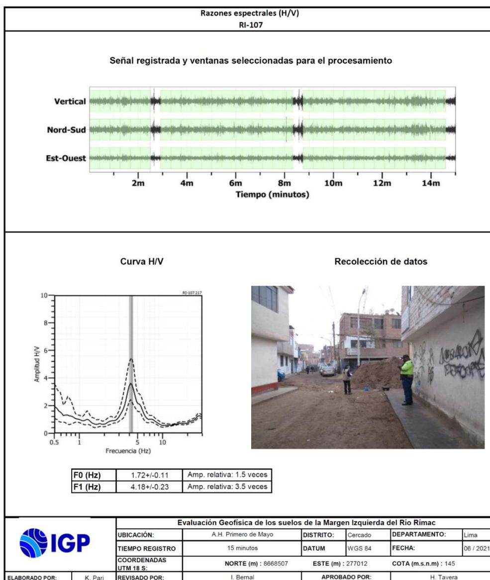
Figura 20. Resultados obtenidos con el método de razones espectrales (H/V) para el punto RI-107. Arriba, la señal registrada y abajo la curva promedio de las razones espectrales (H/V) en línea gruesa y su desviación estándar en líneas discontinuas. Las barras grises, definen la frecuencia predominante.
