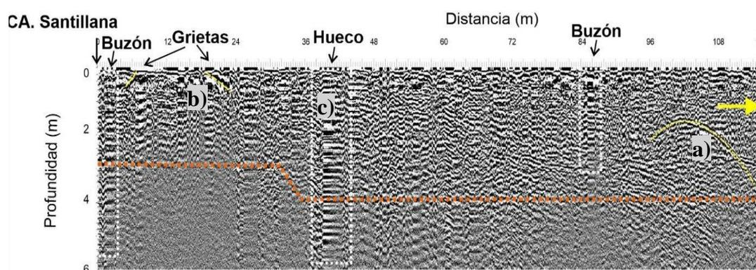
Figura 43. Radargrama, con los diferentes tipos de reflectores asociados a anomalías de tipo hiperbólico (a), lineal (b) y puntuales (c).
