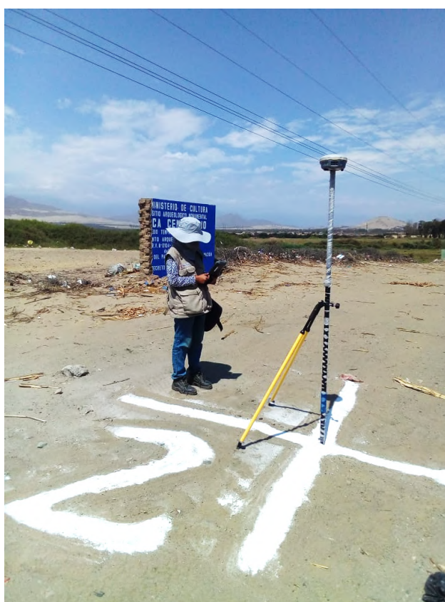
Figura 1. Punto de fotocontrol STA02. En la imagen se distingue al operador junto al equipo GPS rover realizando la adquisición de datos.
