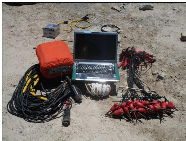
Figura 26. Equipos utilizados en la toma de datos por el método de MASW.
