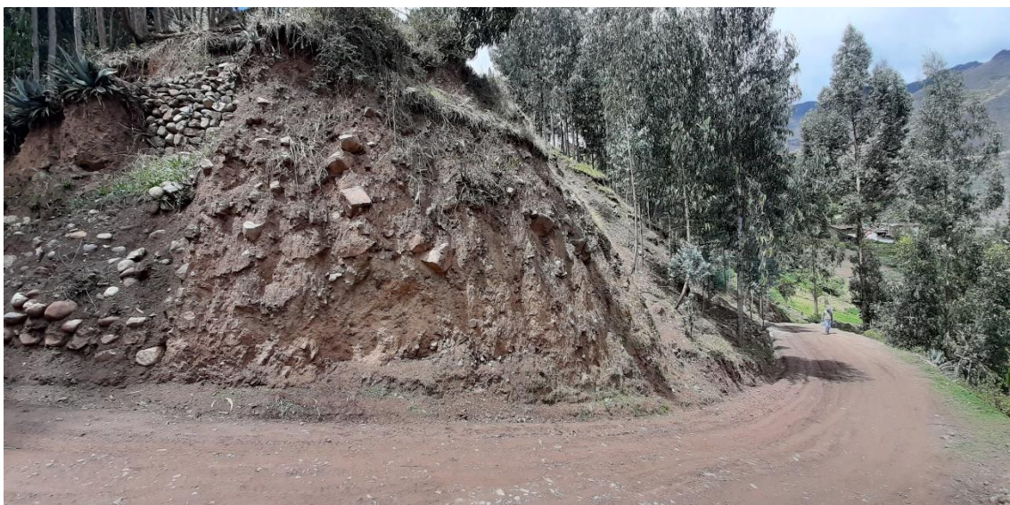
Figura 6. Arcillas y gravas con matrices arcillosas y limosas que cubren a la Formación Chimú, sobre este tipo de materiales se asienta el Centro Poblado Challhuayaco.
