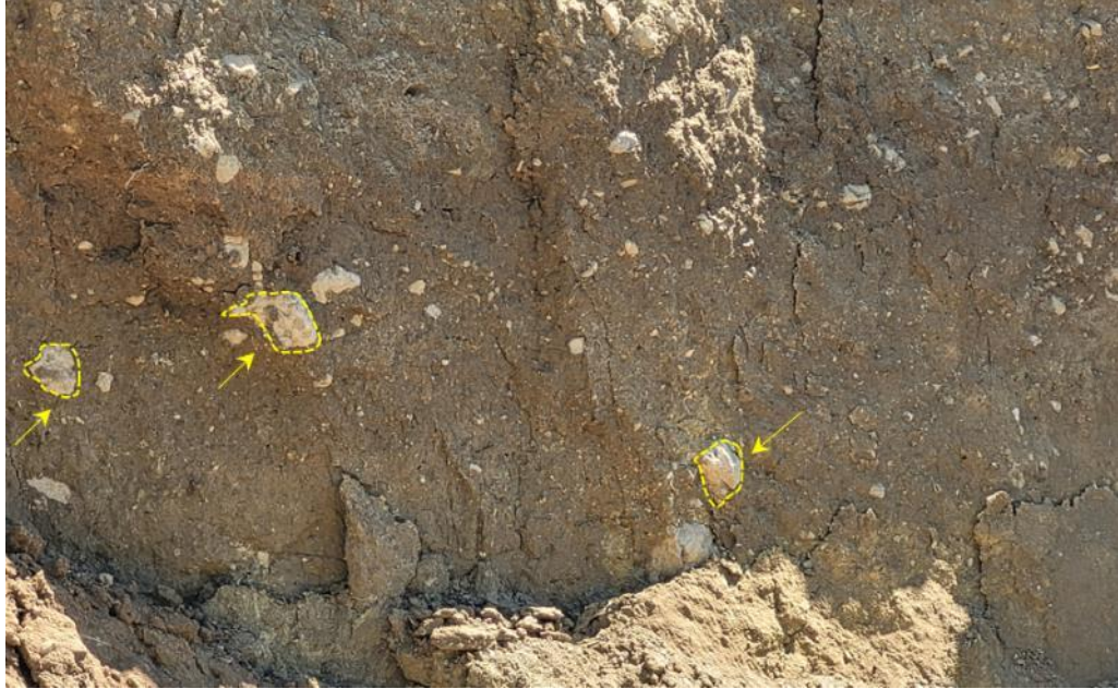
Figura 4. Depósito coluvio-deluvial, compuesto por bloques y clastos de origen calcáreo, dentro de una matriz limo arcillosa.
