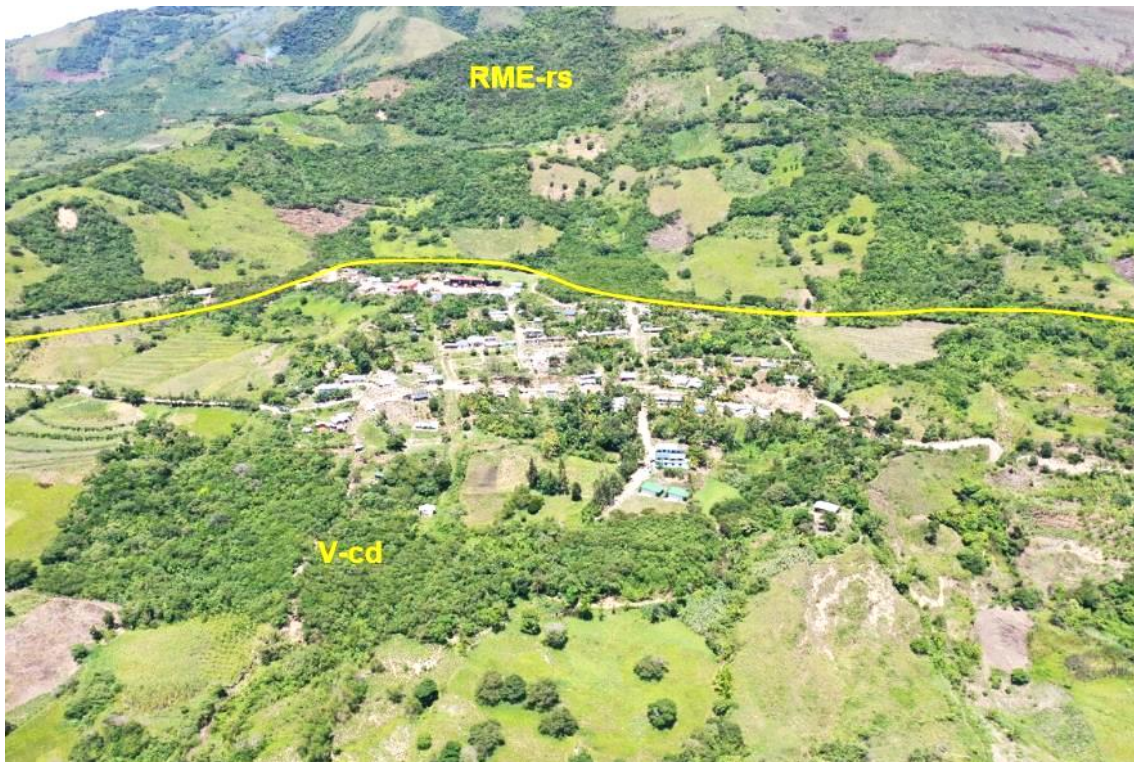
Figura 6. Subunidades geomorfológicas en el sector evaluado, montaña estructural en roca sedimentaria (RME-rs) vertiente o piedemonte coluvio – deluvial (V-cd).
