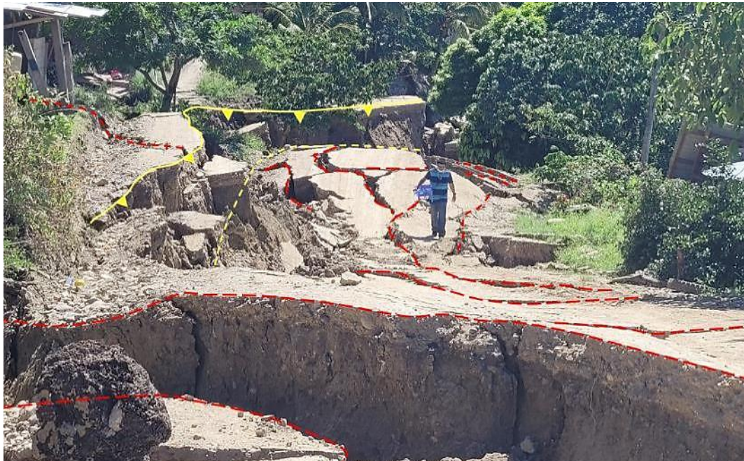
Figura 9. Escarpe secundario y grietas distribuidas en diferentes direcciones dentro del cuerpo en movimiento. Coordenadas UTM WGS84, Norte: 9385502 – Este: 778981
