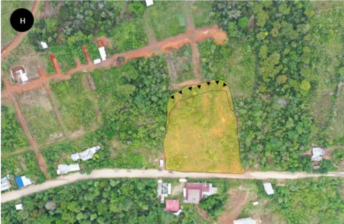
Figura 17. Deslizamiento de falla rotacional de única escarpa en km 125 de carretera San Ignacio a Jaén (116041296), forma de escarpa elongada, con salto de escarpa de 15m.
