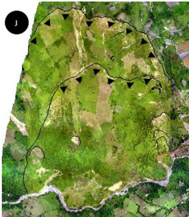
Figura 24. J, Ortofoto de deslizamiento estilo escarpas múltiples, en caserío Santo Domingo del Progreso, distrito Huarango.
