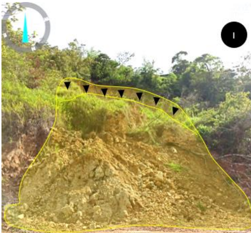
Figura 20. Forma del escarpe semicircular, longitud de escarpa 60m aproximadamente, desnivel entre escarpa y pie 40m aproximadamente, superficie de falla rotacional, Salto de escarpa de 15m.
