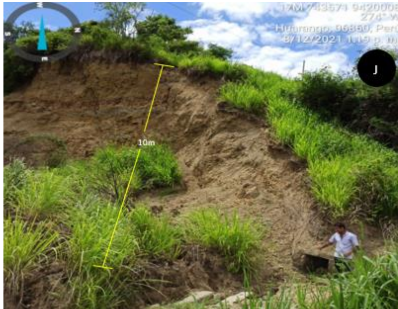
Figura 23. J, Escarpa principal de 10 m en deslizamiento estilo escarpas múltiples, en caserío Santo Domingo del Progreso, distrito Huarango.
