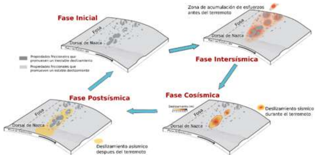
Figura 3. Esquema representativo del ciclo sísmico, donde se muestra los procesos de acumulación y relajación de esfuerzos en las fases principales: fase intersísmica, fase cosísmica y fase postsísmica. Modificado de www.tectonics.caltech.edu/ .
