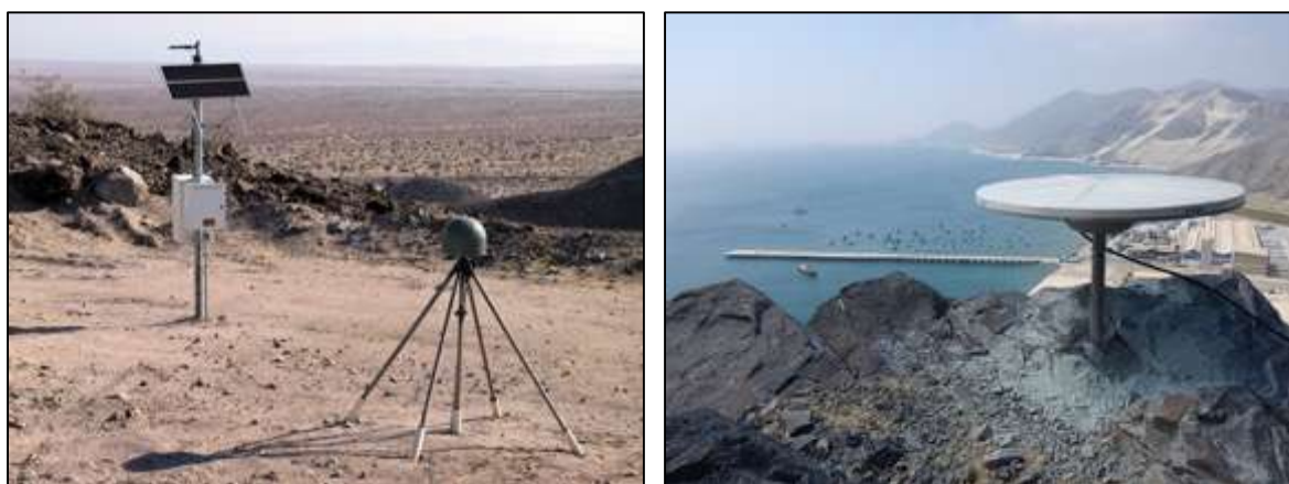
Figura 4. Estaciones GNSS de monitoreo permanente (izquierda, fotografía de UNAVCO) y de campaña (derecha) fotografía de la estación SAMC en el departamento de Ancash).
