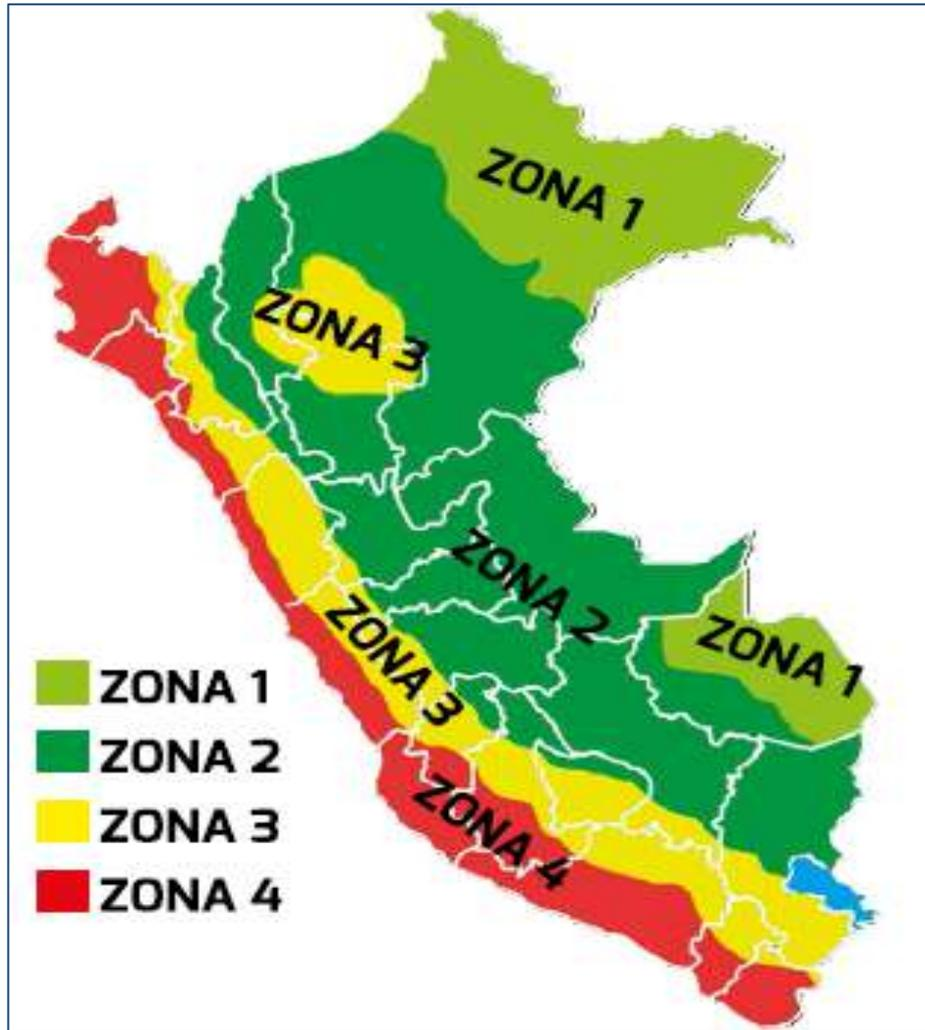
**Figura 5:** Zonificación Sísmica del Perú. E030 Diseño Sismorresistente
