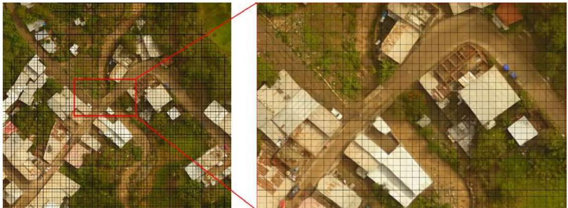
**Figura 5.** Vista general y ampliada del mallado computacional de 1 metro de resolución espacial
