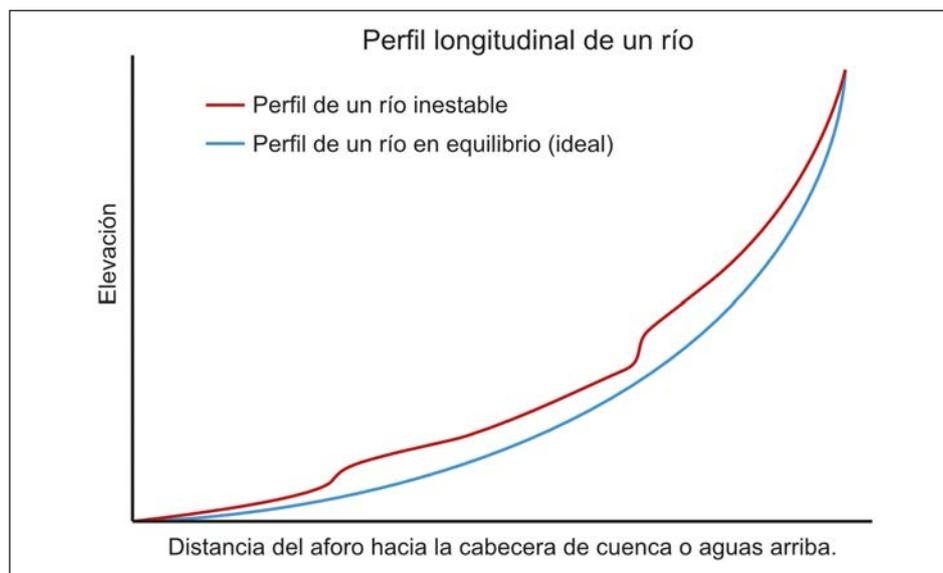
**Figura 5.3** Perfil longitudinal de un río. En línea azul se muestra el perfil de un río en estado de equilibrio; en línea roja se muestra el perfil de un río inestable.
