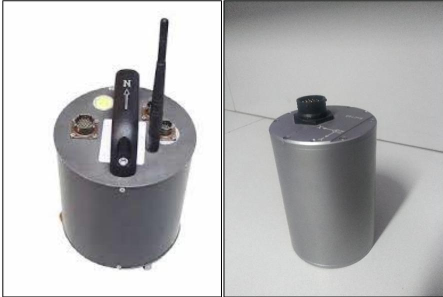
**Figura 2.** Sensores sísmicos Guralp 6TD (izquierda) y Silicon (derecha).
