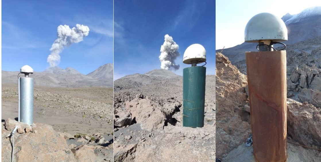
Figura 3.2. Estaciones GPS de la red de vigilancia geodésica del volcán Sabancaya durante el 2019. De izquierda a derecha, estación GPS SBMU, SBHO y SBSE.
