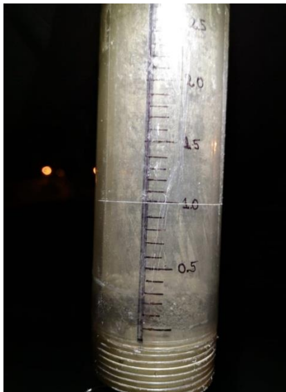
Figura 6.15. Cenizómetro UC-03, recolectado 0.2 mm de caídas de cenizas
