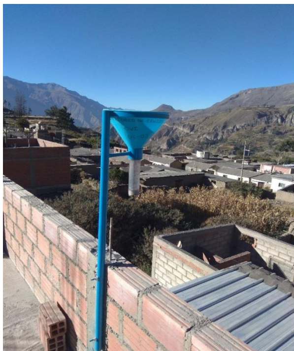
Figura 6.2. Tipo y característica del cenizómetro, ubicado en la azotea de una vivienda en el pueblo de Ubinas.
