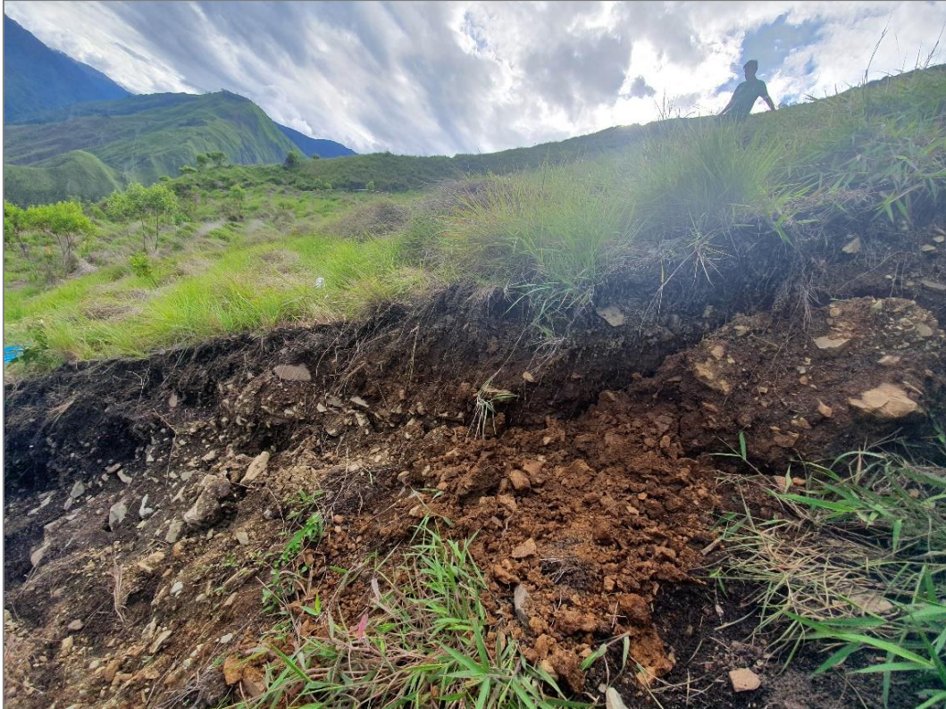
Fotografía 1. Material coluvio-deluvial, compuesto por fragmentos de pizarras y esquistos, con diámetros que varían de 0.30 m a 1 m; de formas angulosas a subangulosas, inmersos en matriz arenosa arcillosa. Fuente: Ingemmet, 2020.
