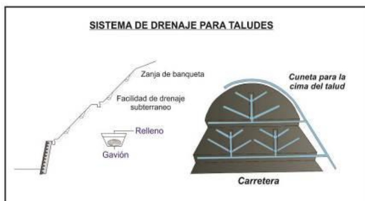
Figura 20. Sistema de drenaje tipo espina de pez.
