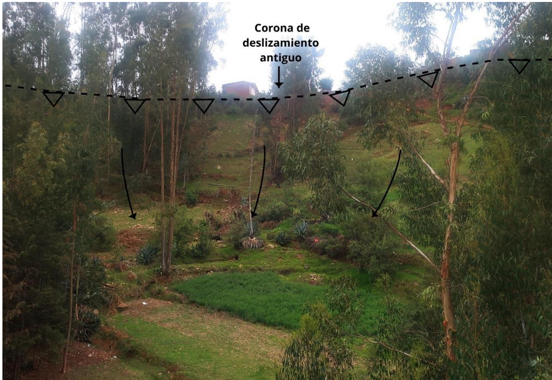
Figura 17: Se muestra corona de deslizamiento antiguo en el centro poblado de Allmay, también se observan viviendas ubicadas a muy pocos metros del escarpe del deslizamiento
