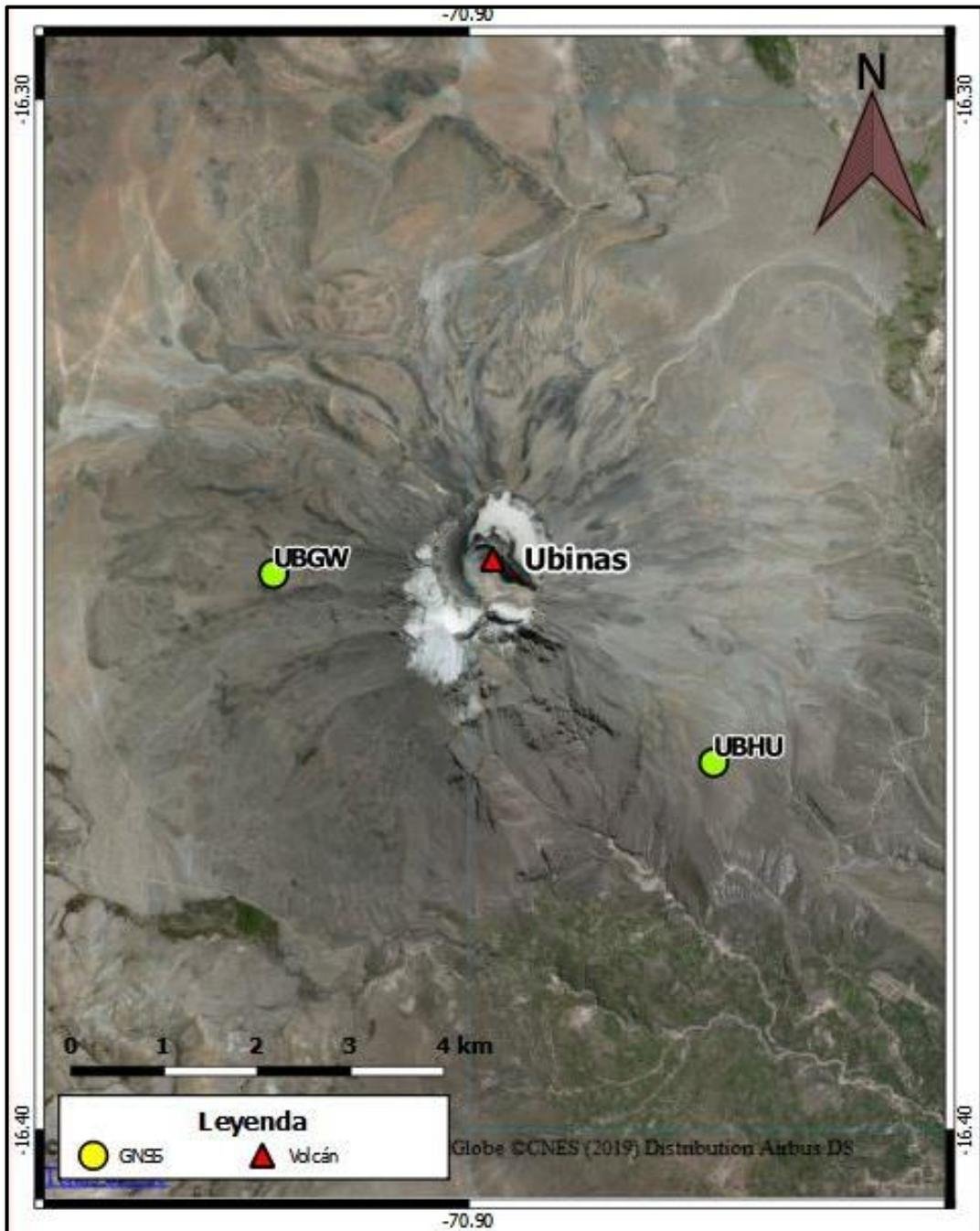
**Figura 5.** Red geodésica de estaciones GNSS de operación continúa del volcán Ubinas durante el 2019.
