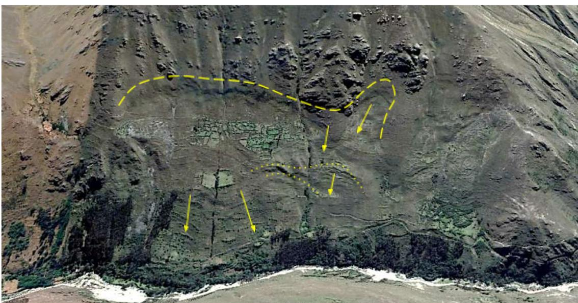
**Figura 10: Deslizamiento aparentemente activo, en la margen derecha del río Shullcas. La línea discontinua superior, señala el escarpe principal y las líneas punteadas, escarpes secundarios, las flechas indican evidencias de deformación superficial.**
