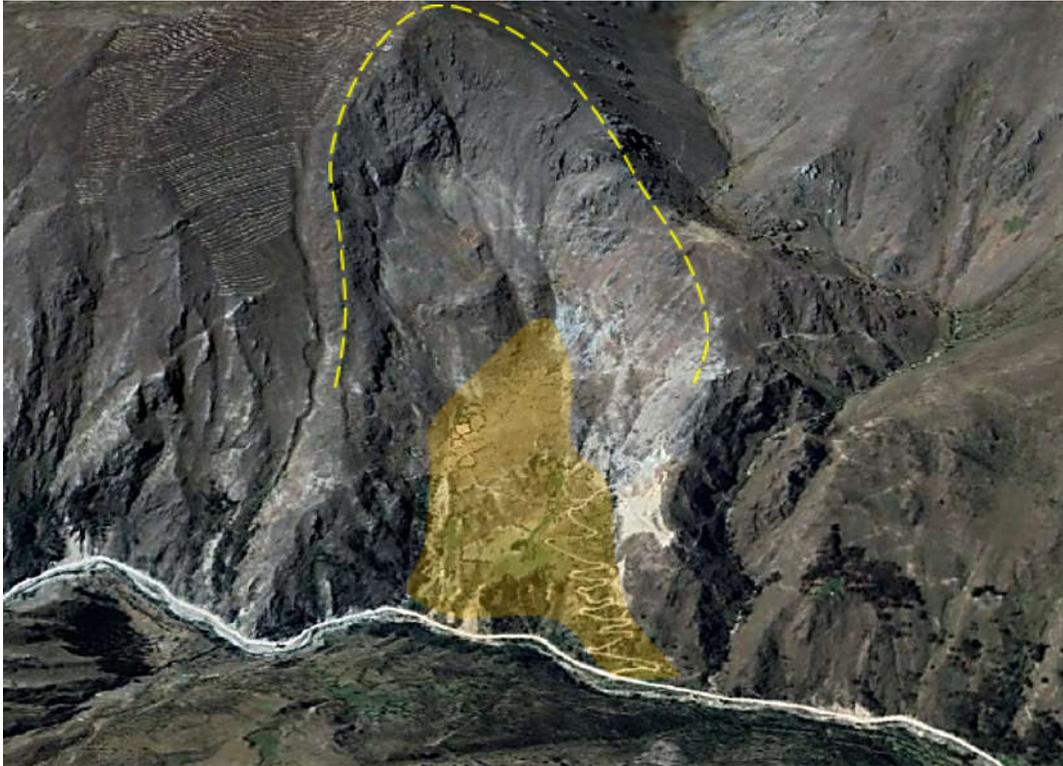
**Figura 11: Deslizamiento antiguo, aparentemente inactivo, en la margen izquierda del río Shullcas**
