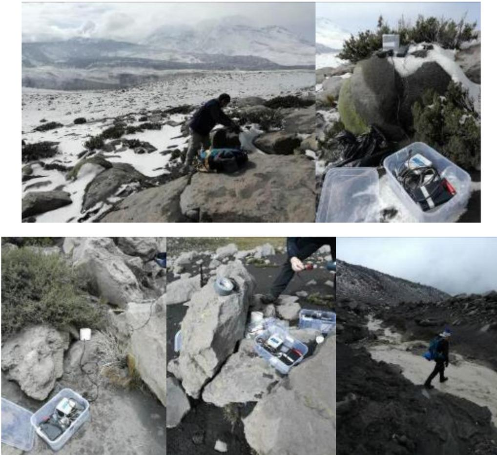
**Figura 7.2.** Trabajos de campo para la instalación de sensores de infrasonido en el volcán Sabancaya.
