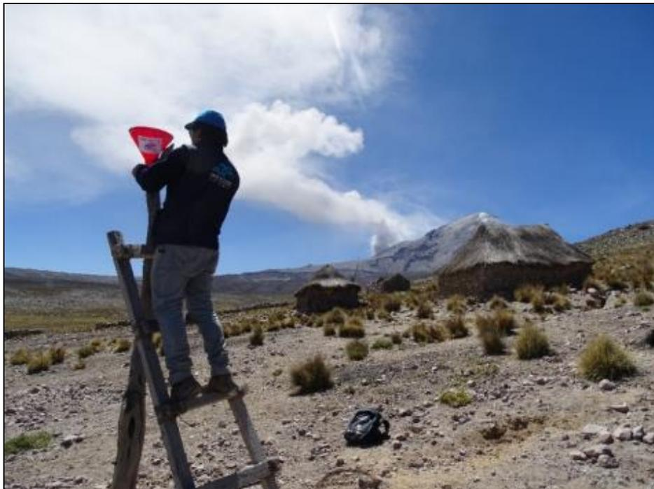
*Figura 3.1. a) Instalación de cenizómetros en el sector de Collpa, Suroeste del volcán Sabancaya.*
