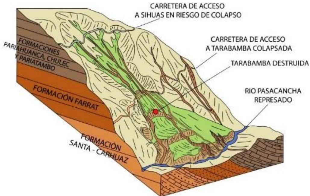
**Figura 6: Esquema de un deslizamiento rotacional ocurrido en Tarabamba – Ancash, ocurrido tras la reactivación de un deslizamiento antiguo (Elaborado por: Concha, 2015). El caso es muy similar al deslizamiento de Piyay.**
