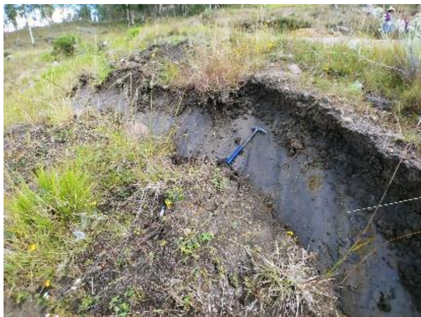
Foto 7: Escarpe, presenta con manchas de color gris, indican la presencia de la napa que permiten el proceso de aceleración del movimiento.
