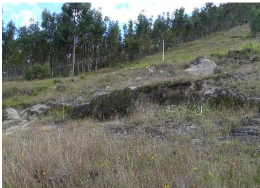
Foto 2. Afloramiento de rocas volcánicas, se muestran muy meteorizadas. (Punto N° 01).
