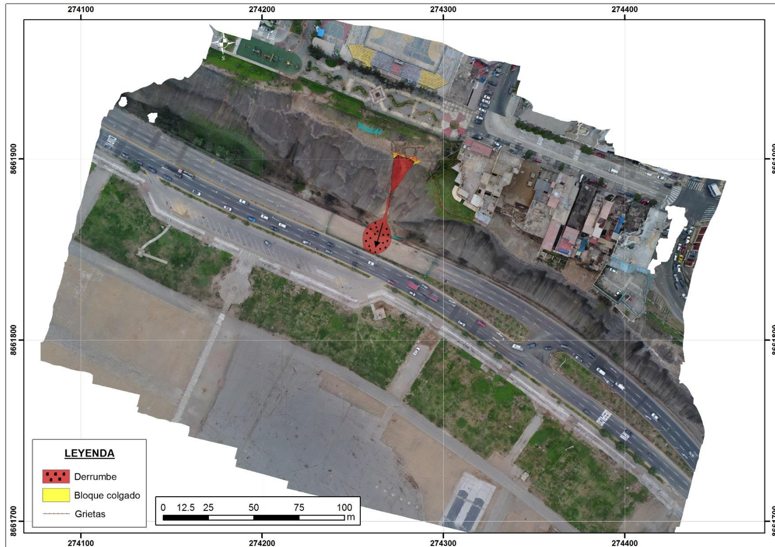
Figura 7.2: Ortofoto del acantilado de la Costa Verde, sector malecón Castanogla donde se identifica los movimientos en masa ocurridos en la zona.
