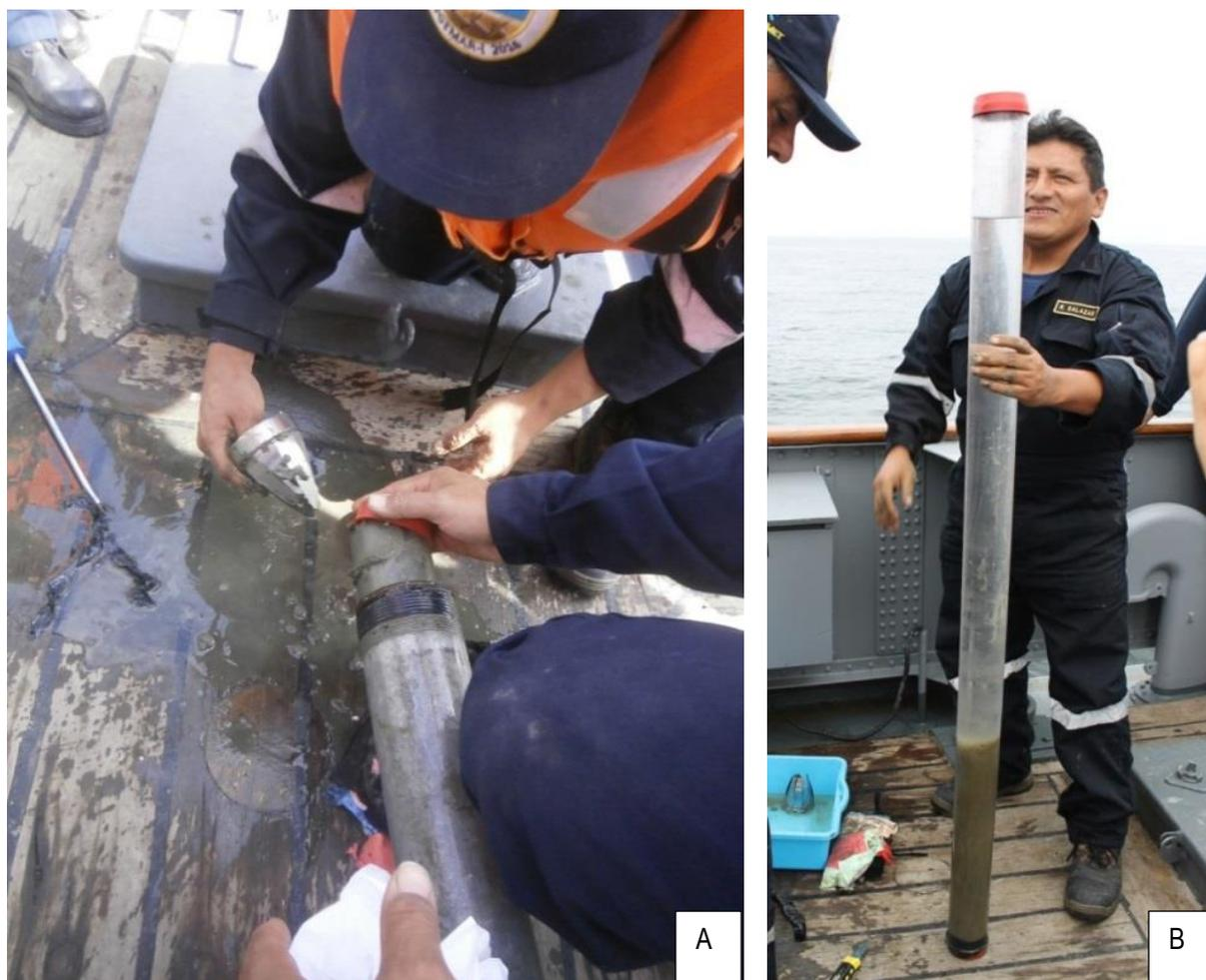
**Figura 3.4.** A. Extracción del colector de testigo y sellado de la parte inferior del *liner*. B. Liberación del *liner*, giro a posición vertical y sellado con tapa plástica del extremo superior. (Crucero INGEMAR I).
