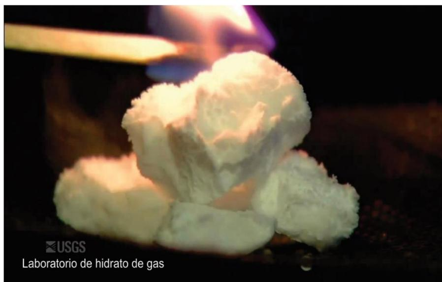
Figura 8.3. Hidratos de gas (tomado de Laboratorios de USGS)
