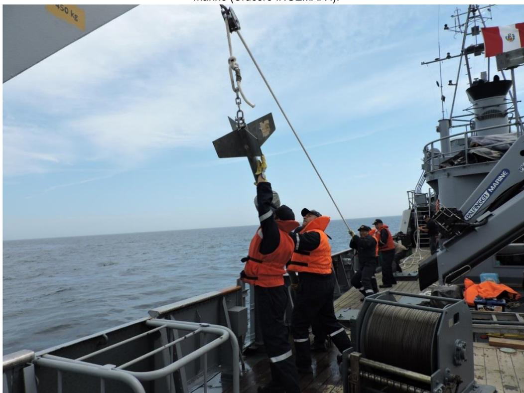
**Fotografía 3.7.** Recuperación de la perforadora de gravedad. (Crucero INGEMAR I).
