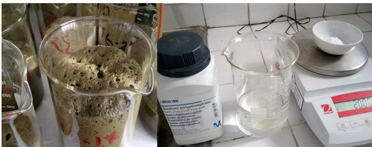
Figura 3.7. Reacción de la materia orgánica en frío, con peróxido de hidrógeno (reducción de la materia orgánica)
