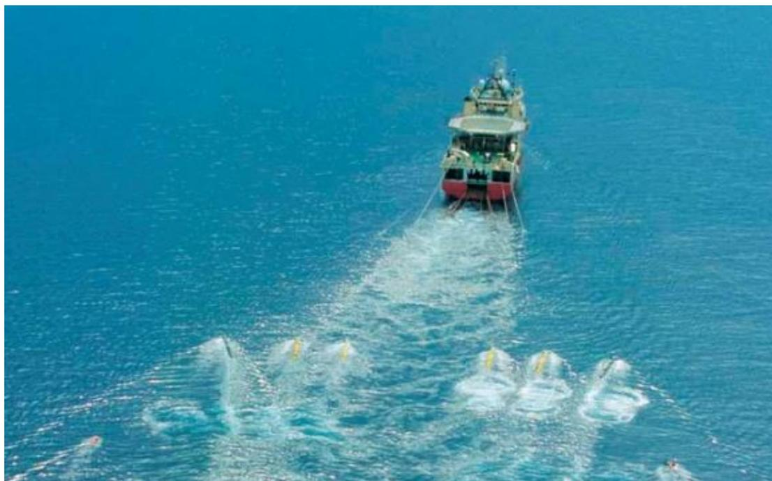
**Fotografía 3.11.** Prospección sísmica con aire comprimido; hidrófonos colocados en 8 cables de 8 km de longitud cada uno. ([www.El mundo es/baleares 72013/12/16](http://www.El mundo es/baleares 72013/12/16)).
