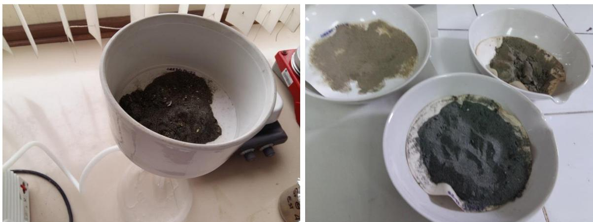
Figura 3.8. Secado de muestras en estufa a temperatura no mayor de 35°C.
