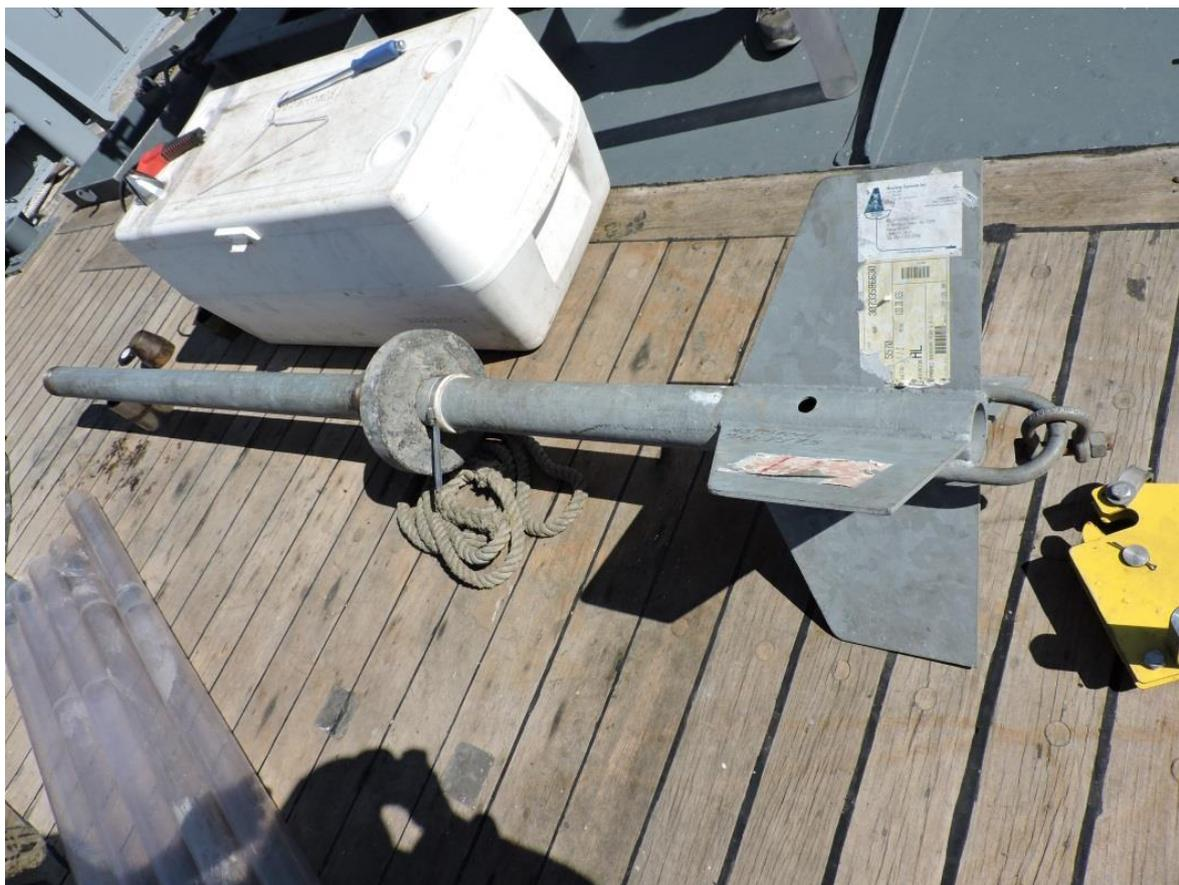
**Fotografía 3.6.** Sistema de pesas y aletas que otorgan peso y estabilidad para el lance y penetración del equipo en el lecho marino (Crucero INGEMAR I).
