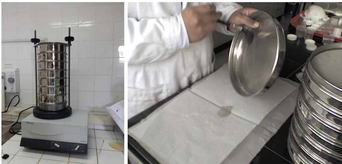
Figura 3.9. Sedimento retenido en una de las mallas tamizadas. B. Sedimento sobre el papel cansón.
