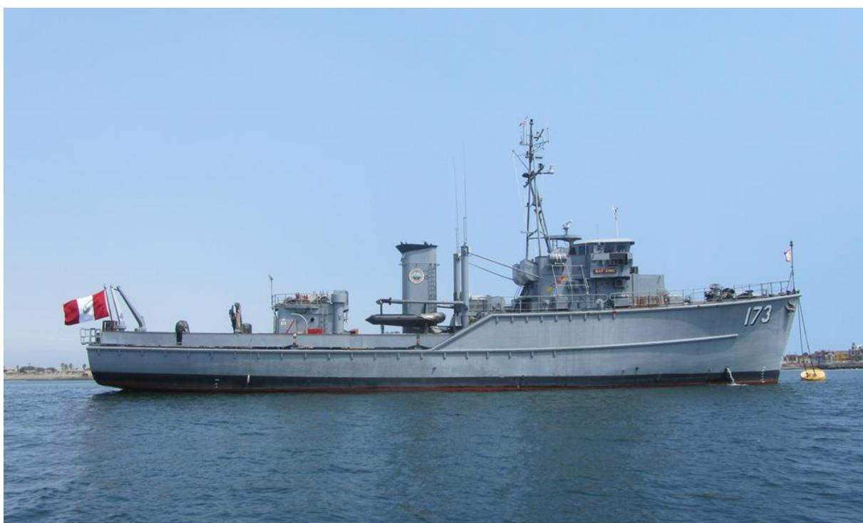
**Fotografía 3.10.** El Buque de la Armada Peruana, BAP Zimic, equipado con ecosonda multihaz EM302 Kongsberg. ([https://www.dhn.mil.pe/index.php?secc=unid\\_hidrograficas&und=carrasco](https://www.dhn.mil.pe/index.php?secc=unid_hidrograficas&und=carrasco))
