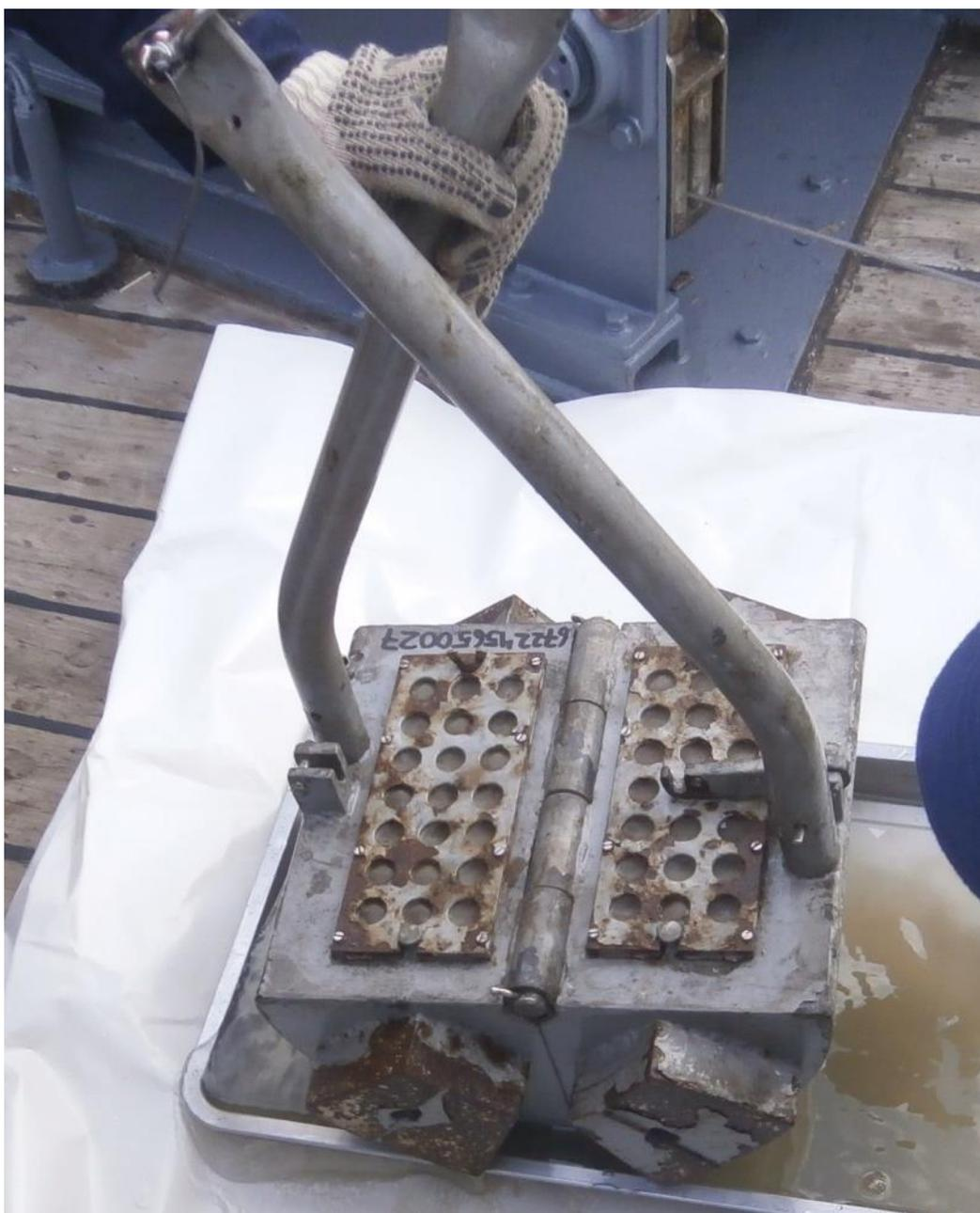
**Fotografía 3.2.** Draga tipo Van Veen: Sistema de cucharas o mandíbulas, sistema de pesas laterales para asegurar una mayor penetración, y mallas para expulsión de agua una vez coleccionado el sedimento. (Crucero INGEMAR I).
